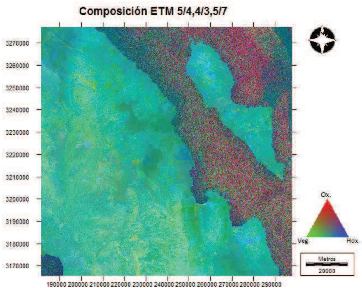
Figura 6.7 Composición de cocientes de bandas. En tonos azul y magenta las zonas con alteración hidrotermal, en verde las zonas cubiertas por vegetación.
