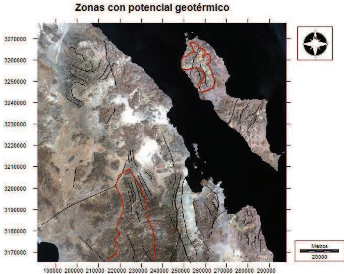
Figura 7.2 Zonas con mayor potencial para la exploración geotérmica (en contorno rojo). En líneas negras los lineamientos principales.
