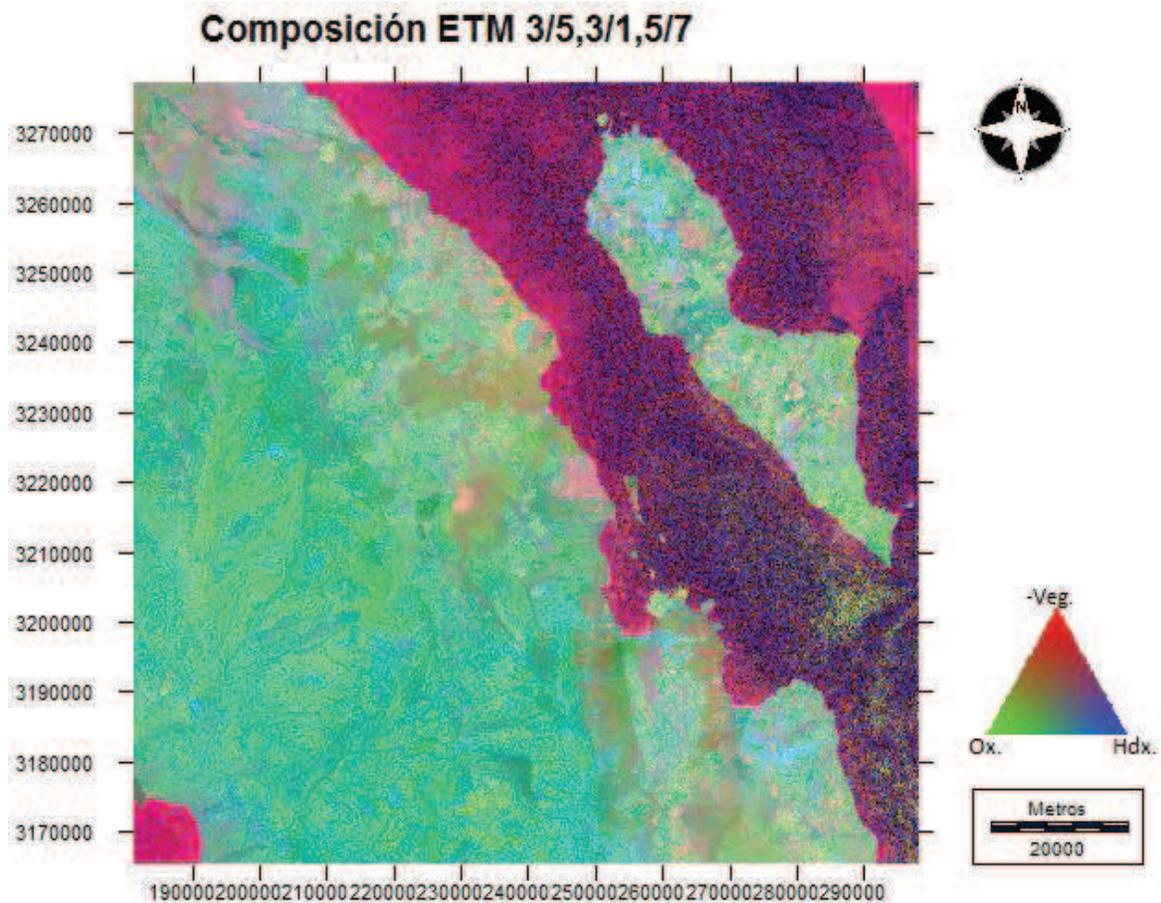
Figura 6.8 Composición de cocientes de bandas. En tonos amarillo y anaranjado las zonas con alteración hidrotermal.
