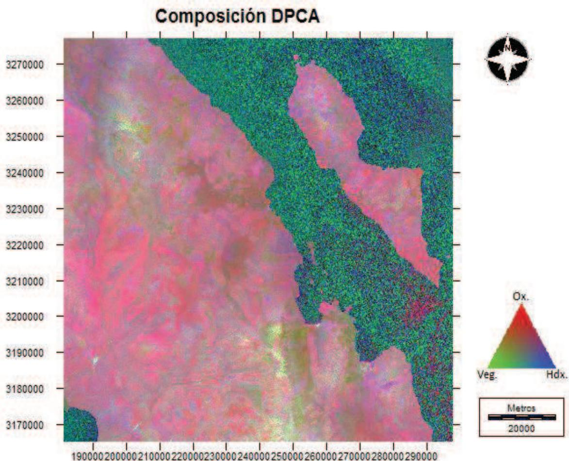
Figura 6.11. Composición de DPCA. En tonos rojos los óxidos, en verde la vegetación, en azul los hidroxilos, y en magenta las zonas de alteración hidrotermal.
