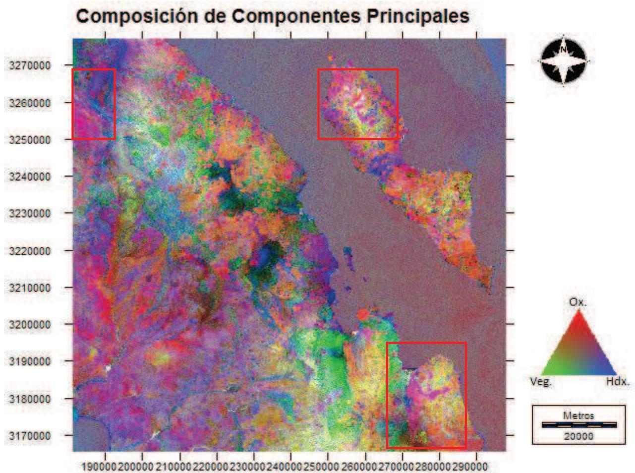
Figura 6.9 Composición de componentes principales C3, C5, C4 (Óxidos., Vegetación, Hidroxilos)
