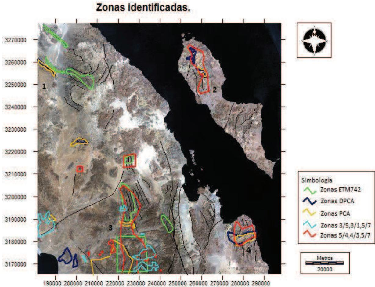
Figura 7.1. Despliegue simultaneo de las zonas de alteración identificadas en cada imagen resultante. Se puede observar que en algunos sitios se empalman los polígonos, éstas son las zonas con mayor potencial de exploración.
