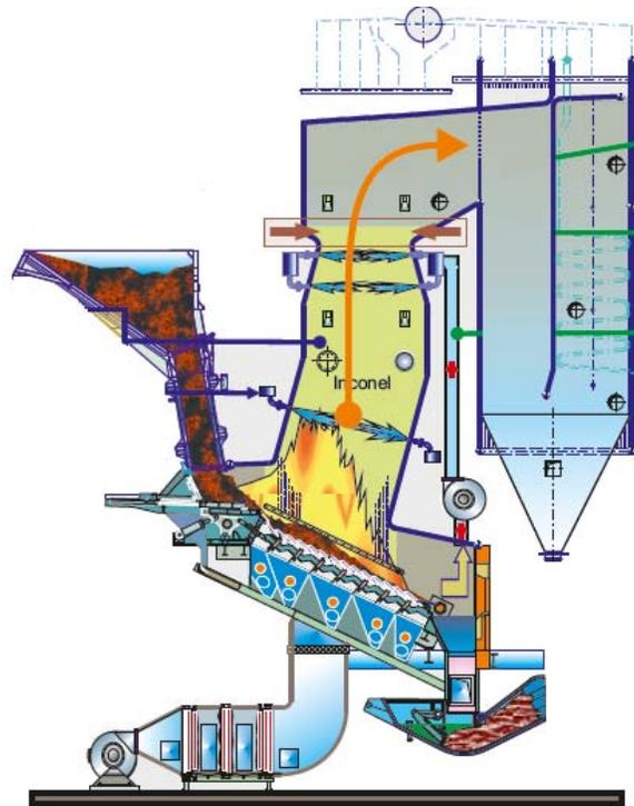
Figura 5. Esquema de horno de parrilla móvil
