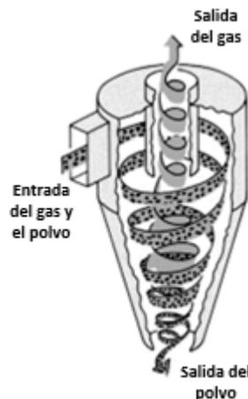
Figura 11. Mecanismo de separación de partículas mediante ciclón.
