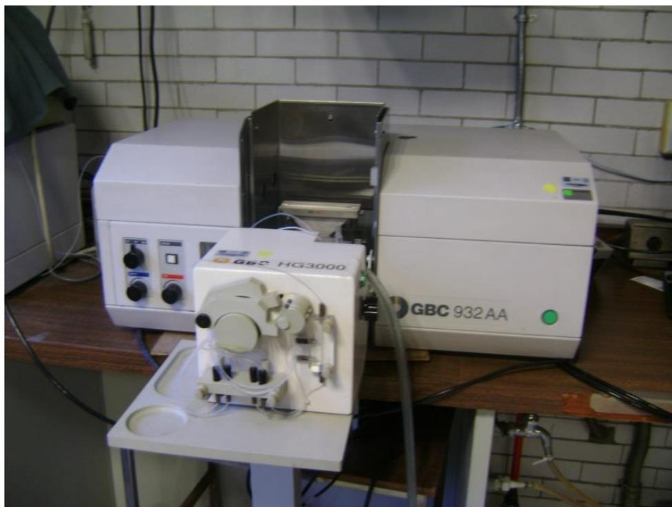
Figura 7. Espectrofotómetro propiedad del Centro de Ciencias de la Atmósfera de la UNAM. Espectrofotómetro GBC 932AA. Generador de hidruros GBC HG3000.
