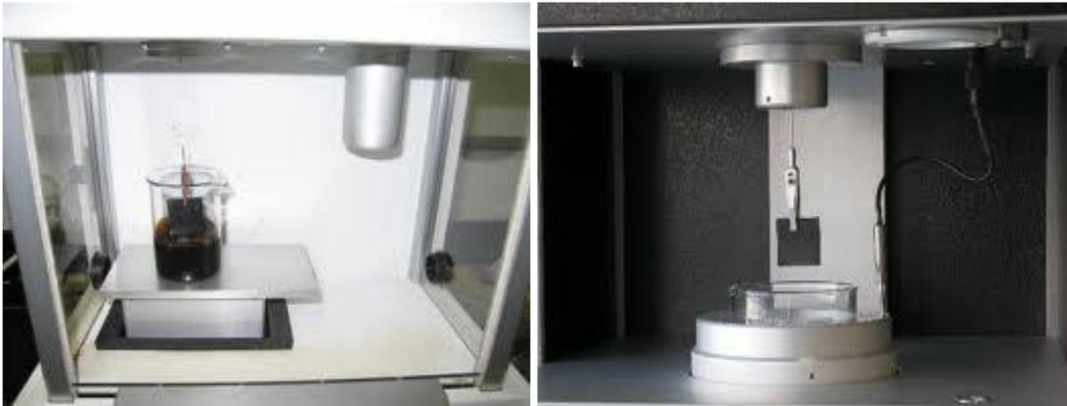
**Figura 13. Tensiómetros comerciales de placa de Wilhelmy.**
