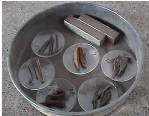
(Fig. 2.6.-Prueba límite de contracción.)
