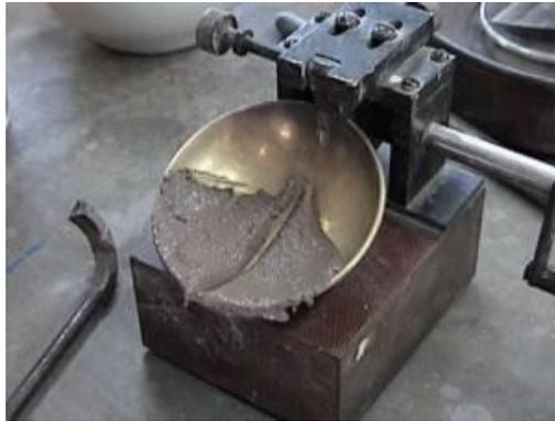
(Fig. 2.7.-Prueba limite líquido.)
