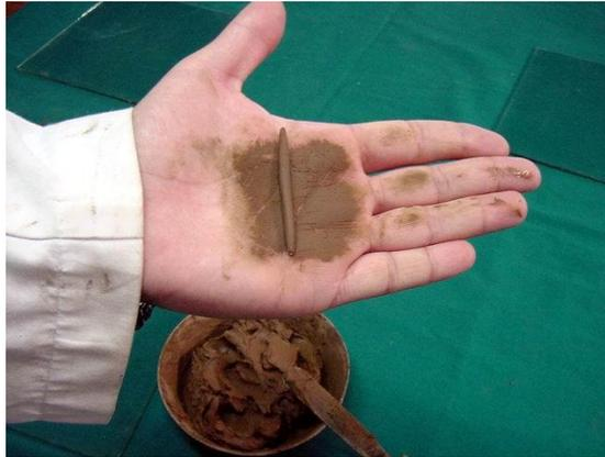
(Fig. 2.5.-Prueba limite plástico.)
