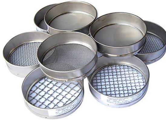
(Fig. 2.4.- Mallas para prueba de granulometría)
