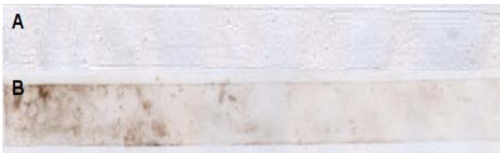
Figura 5.5. Aspecto visual de las membranas de polietileno (PE) después del tratamiento con lacasa y fenol. (A) PE incubado en amortiguador de succinatos 60mM, pH=4.5. (B) PE incubado con lacasa y 1 mM de fenol en amortiguador de succinatos 60mM, pH=4.5.
