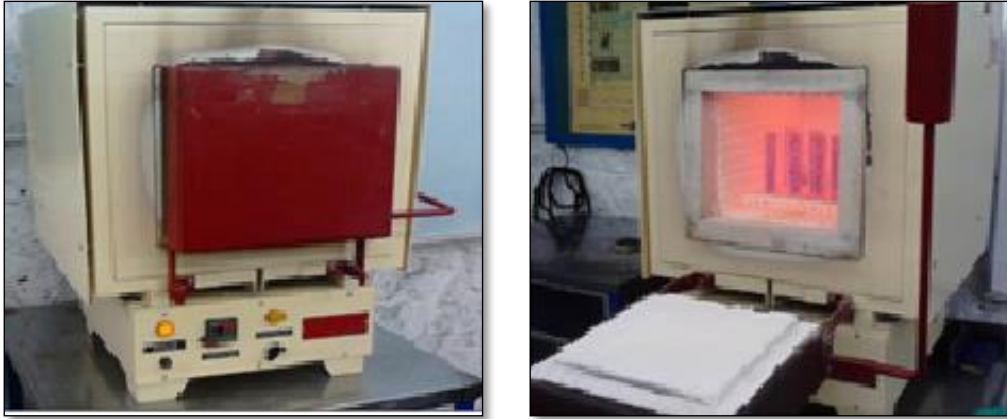
Figura 2.5. Horno industrial para tratamientos térmicos KINTEL AX-2.
