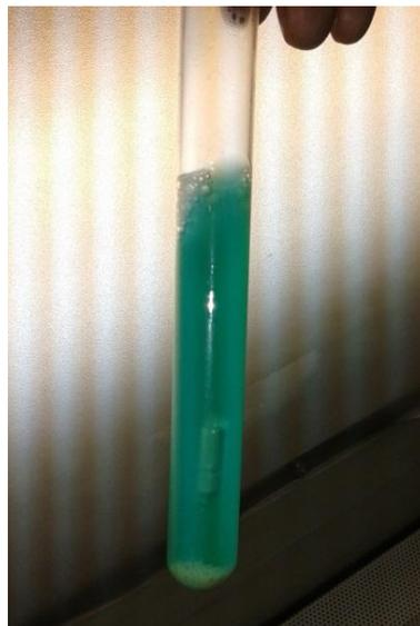
Ilustración 7. Tubo de ensayo, en prueba de coliformes fecales
