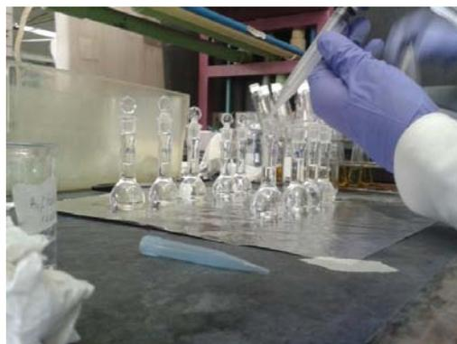
**Ilustración 5. Preparación de curvas patrón para la calibración del Espectrofotómetro de absorción atómica.**
