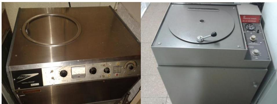
Ilustración 3. Centrifugas donde se separaron los efluentes líquidos y sólidos.
