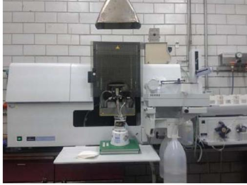
Ilustración 6. Espectrofotómetro de absorción atómica.
