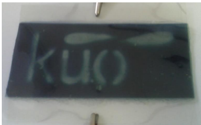
Figura 13. Celda electrocrómica empleada como letrero estático de PET / ITO / PEDOT:PSS // Polielectrolito // PANI:PSS / ITO / PET en estado neutro (transparente), al hacer pasar corriente con el fondo claro y al invertir la corriente con el fondo oscurecido.
