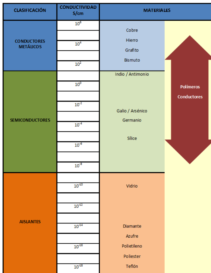
Figura 9. Escala de conductividad eléctrica de diversos materiales.
