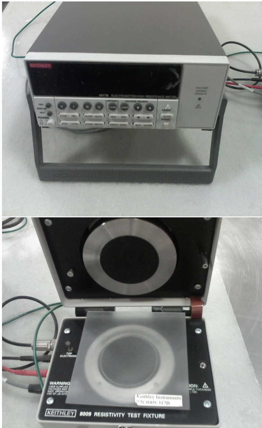
Figura 36. Fotografía del electrómetro Keithley empleado en las mediciones de conductividad eléctrica.
