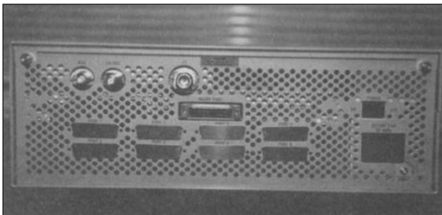
Fig. 2-6. Vista trasera de un IDU de una estación VSAT. [2]
