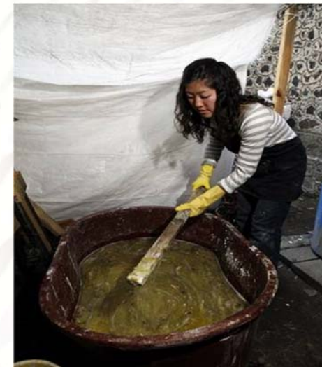
Preparación de impermeabilizante con baba de nopal
