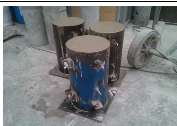
Figura XXII Cilindros de concreto fresco de concreto celular.
