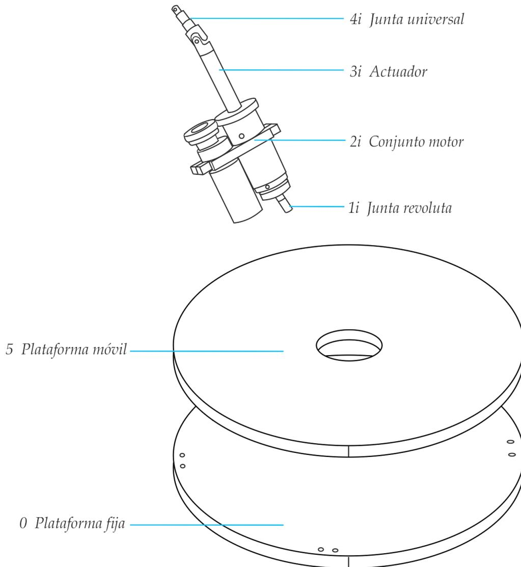
Figura 3.5 Cadena cinemática y Plataforma móvil y fija.
