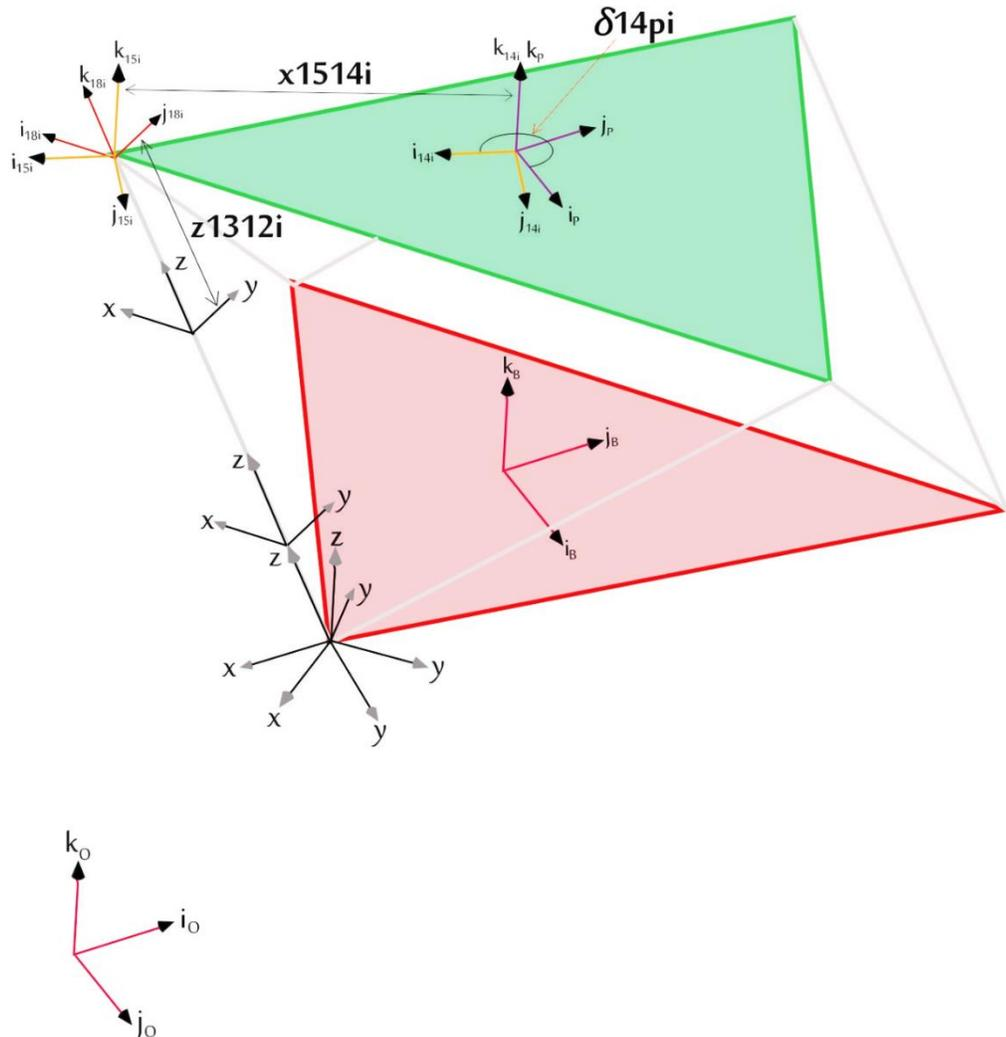
Figura 2.4 Sistemas de referencia del inercial al  $18i$
