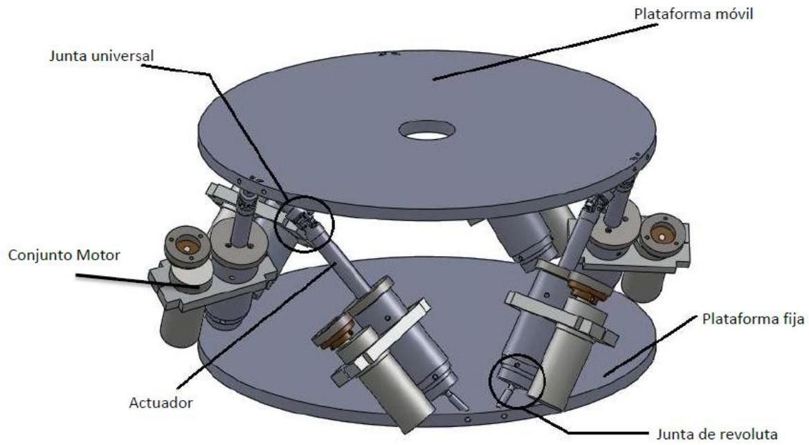
Figura 1.3 Configuración del robot paralelo
