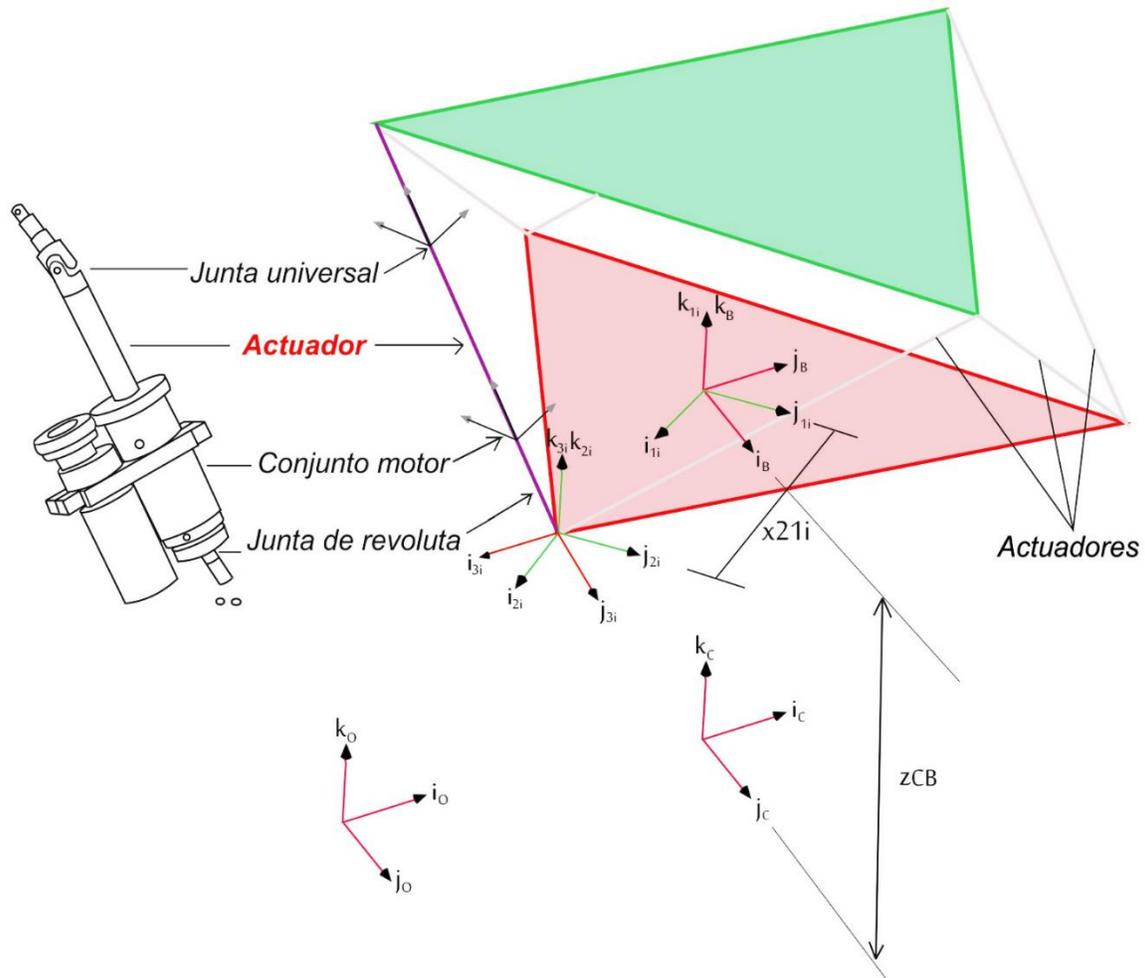
Figura 2.1 Sistemas de referencia del inercial al  $3i$
