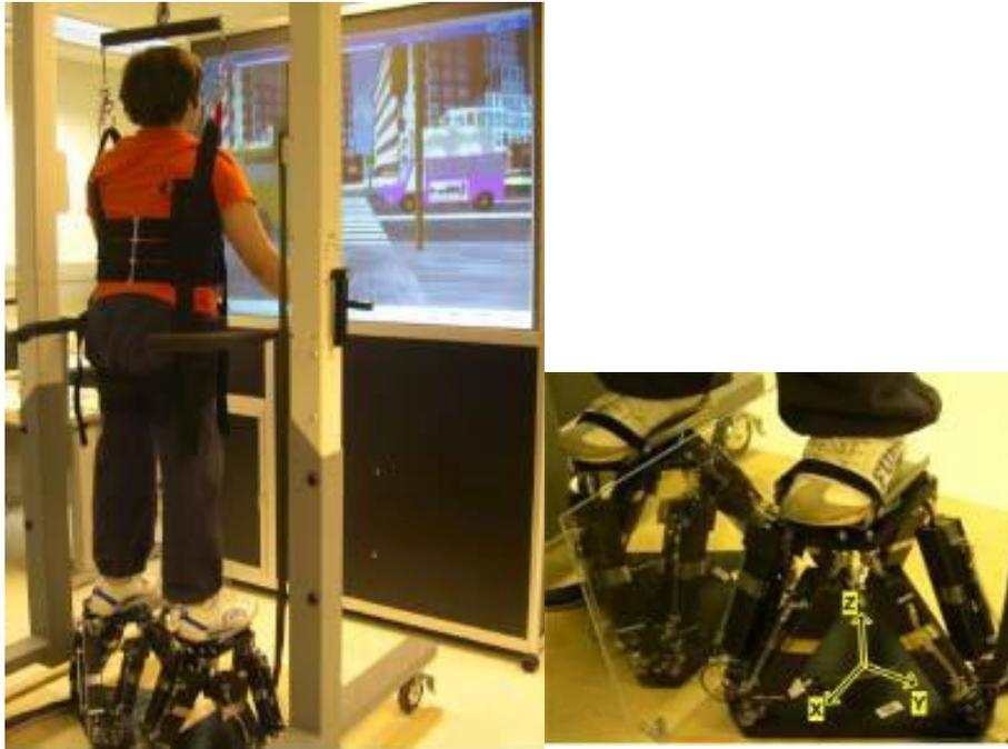
Figura 1.2 Simulador de marcha usando dos plataformas Stewart.
