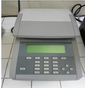
**Figura 12:** Equipo termociclador utilizado, AB9700.
