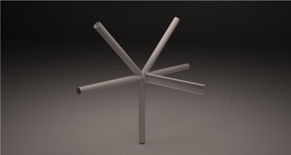
(2) Imagen digital del detalle de un nodo modificado tomando como referencia los empleados en la estructura del museo Soumaya
