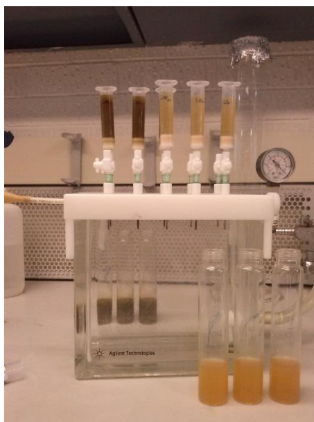
Figura 12 - Percolación de extractos diluidos en cartuchos de SPE
