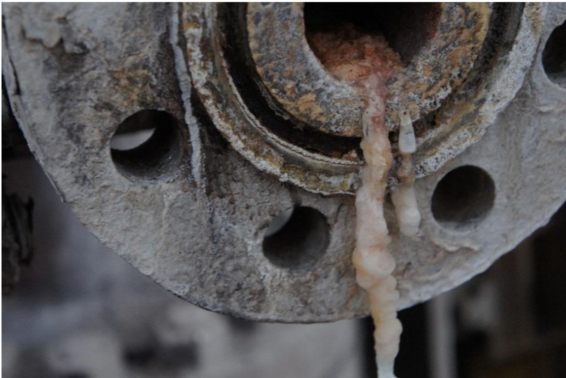
Figura 7.- Incrustación de sílice en el campo geotermoeléctrico Cerro Prieto
