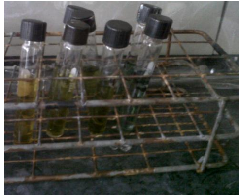
Fig. A4.2 Muestras de cada uno de los efluentes y vinaza listas para ser leídas en el espectrofotómetro
