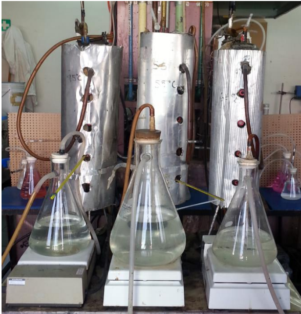
Fig. 10. RALLFA operando a 45, 55 y 65°C (los matracos Erlenmeyer contienen el agua de calentamiento empleando las parrillas donde están soportados)
