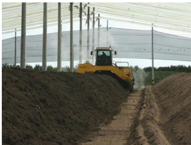
Figura 3. Compostaje industrial de cachaza, ceniza, bagazo, hojas y vinaza concentrada (Ingenio Providencia S. A., 2014)
