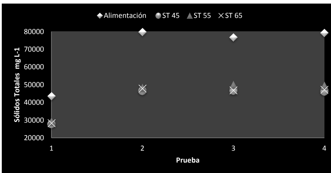
Figura 20. Comportamiento de los sólidos totales, ST, de la alimentación y los efluentes durante el periodo estable (25 días) en los RALLFA
