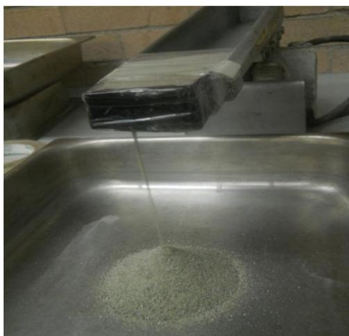
Figura 14. Imagen del alimentador vibratorio con abertura de 5 mm
