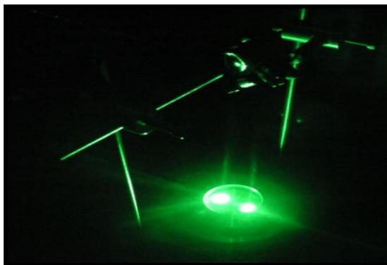
**Figura 2.13 Haz de luz láser modulado y direccionado sobre las ventanas de cuarzo en la muestra y la referencia**
