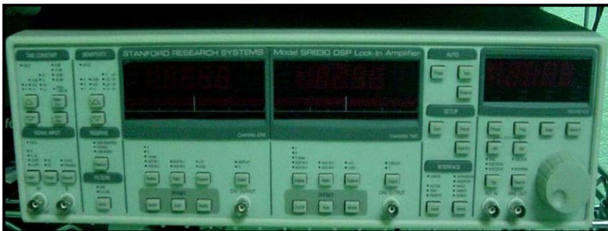
Figura 3.22 Lock-In instalado al sistema fotoacústico
