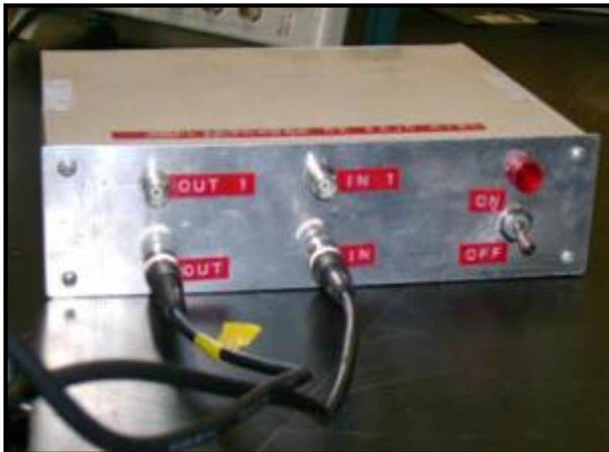
Figura 3.23 Amplificador de la señal
