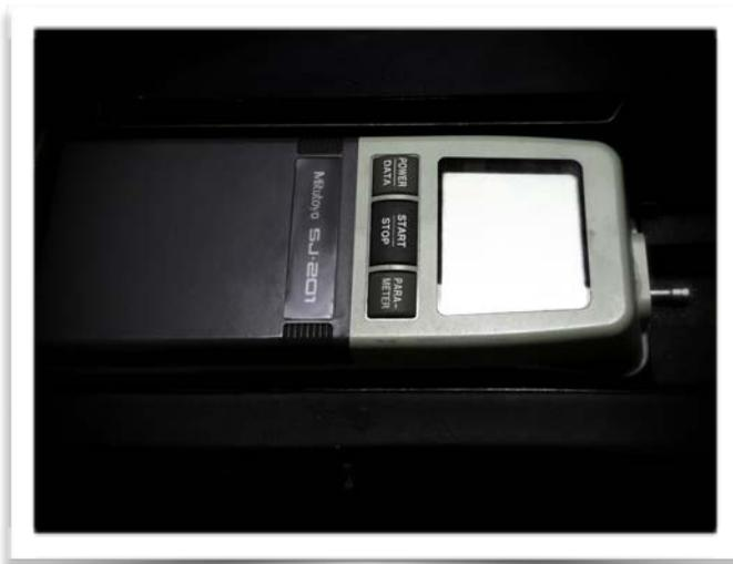
**Figura 36: Vista superior del perfilómetro o rugosímetro modelo SJ-201 de la marca Mitutoyo®.**
