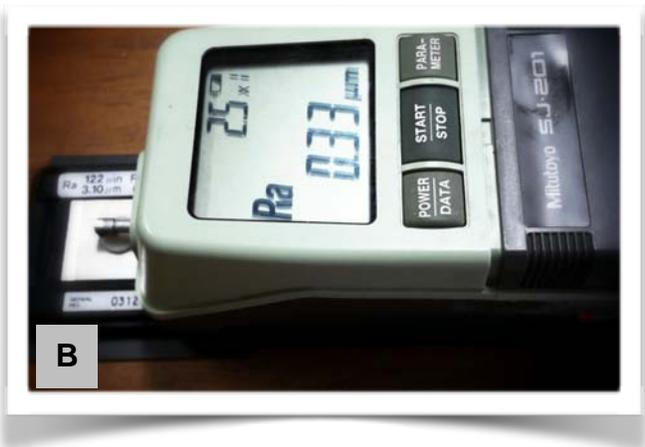
Figura 15: Perfilómetro. (A) Vista lateral del perfilómetro, se aprecia el micropalpador y la punta dispuesta a ser colocada para evaluar una muestra. (B) Vista superior del perfilómetro, se observa en la pantalla registradora la media de la rugosidad ( $R_a$  0.33  $\mu\text{m}$ ) y la longitud de la superficie evaluada (2.5mm). Fuente directa.
