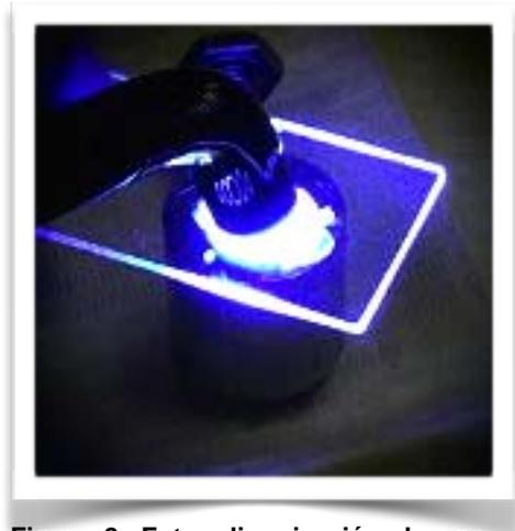
**Figura 2: Fotopolimerización de una resina con luz azul.**
