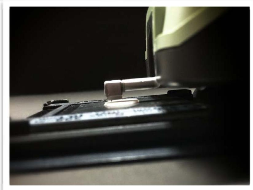
**Figura 37. Vista lateral del perfilómetro durante la evaluación de la superficie de una muestra.**
