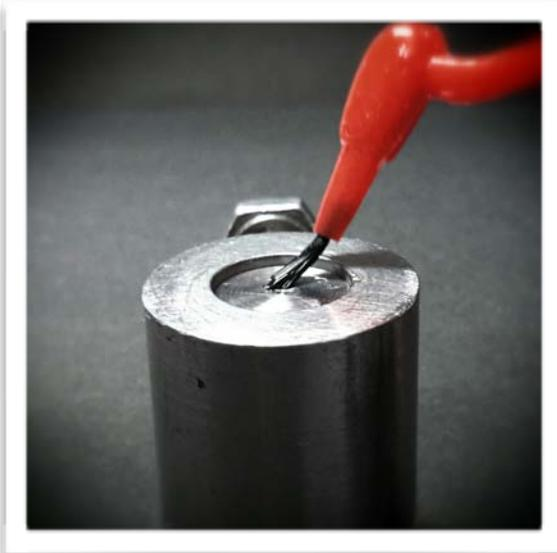
Se colocó la resina en el centro del molde con separador a base de silicona para evitar la adhesión de la resina al molde (Figuras 23 y 24), se presionó con una loseta de vidrio (Figura 25).
