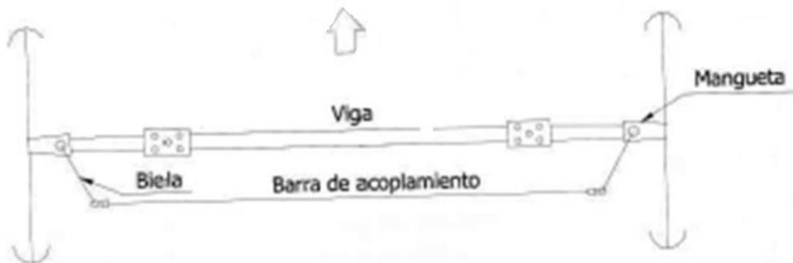
Figura 2.6 Sistema de dirección, vista superior (Cascajosa, 2005)
