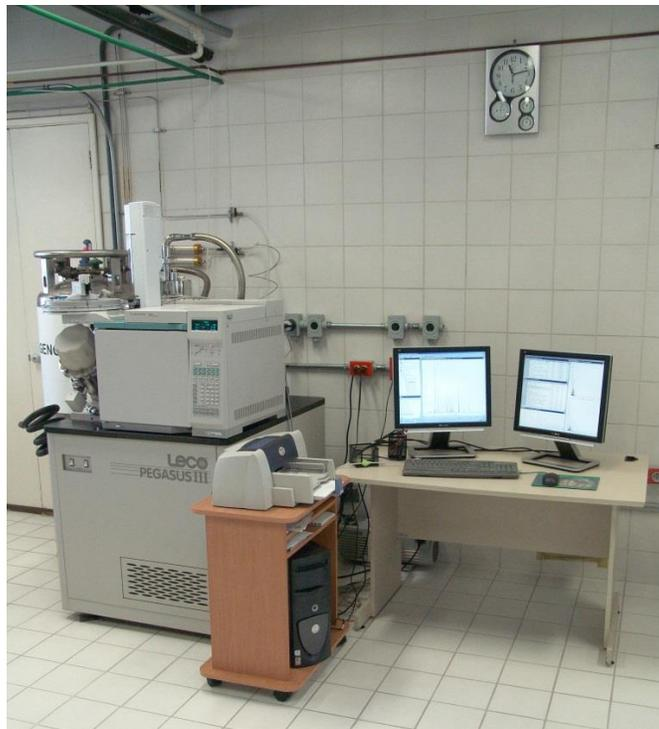
Figura 7. Cromatógrafo acoplado a Espectrómetro de Masas.
