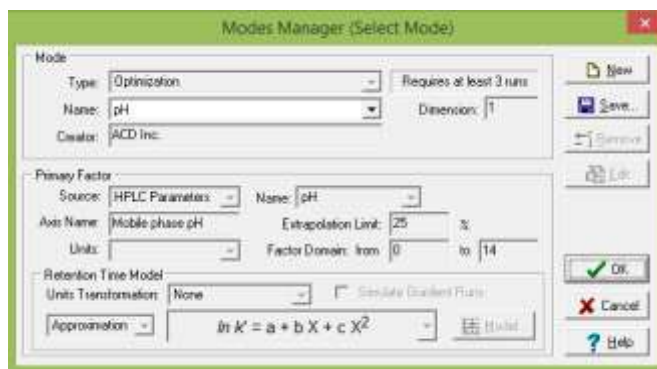
Figura 50. Modelo matemático utilizado para la simulación de la separación cromatográfica con el pH como variable.
