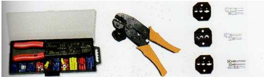
Fig. 5.17 Equipo para prensado de terminales en cables de poca sección. Los alicates de la izquierda, aptos sólo para terminales preaislados, también permiten el corte y pelado de los cables.
