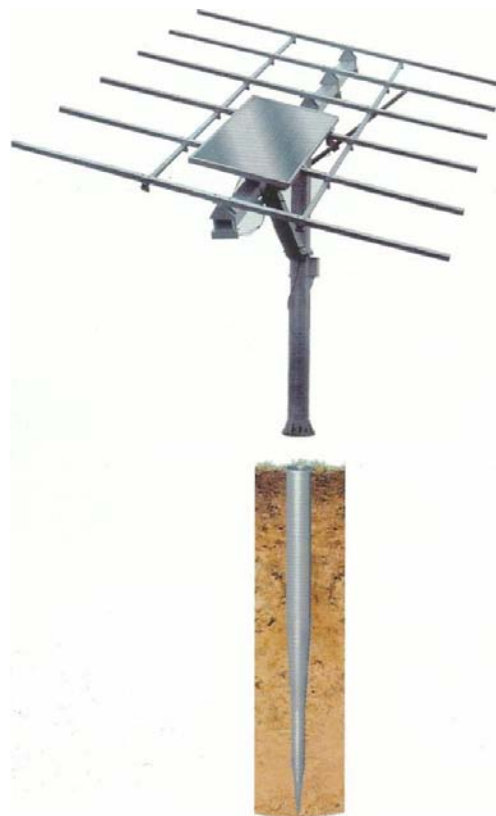
Fig. 3.24 Sistema de "tornillo gigante", que permite enclavar de forma sencilla y segura (siempre que el suelo reúna unas mínimas condiciones) directamente en la tierra el mástil de un seguidor pequeño, "evitando la necesidad de excavar y hormigonar.
