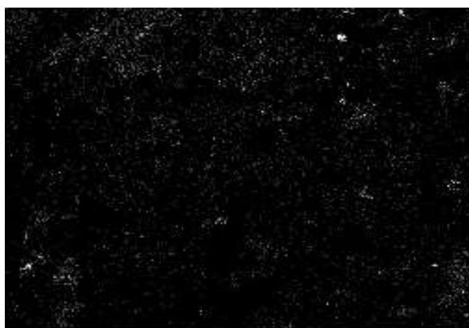
Figura 4.2.2.M Mapeo de cloro sobre la superficie de la Probeta 3B , donde la intensidad de color blanco indica la abundancia del elemento.
