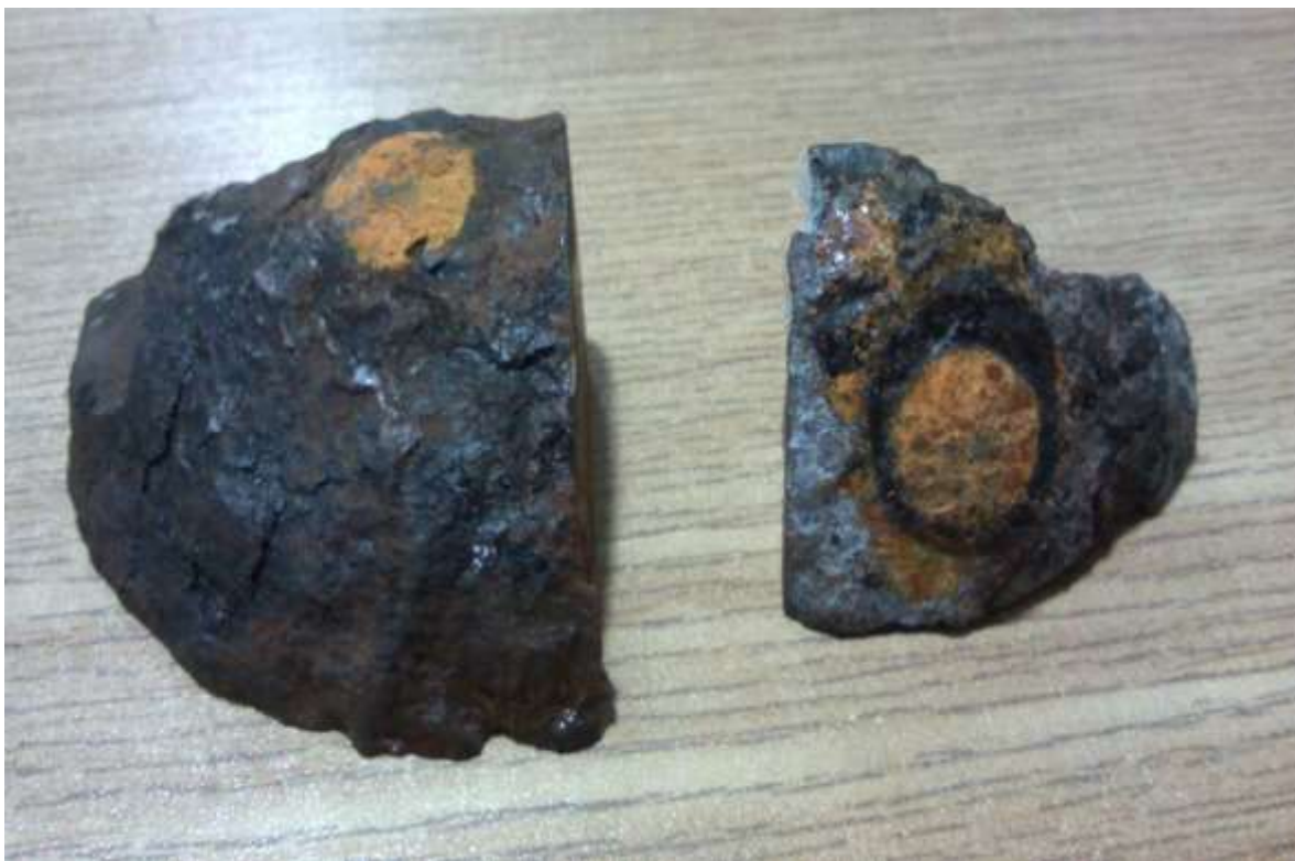
Figura 3.4.C Muestra las probetas de bala de cañón a las cuales se les realizó la extracción de cloruros.
