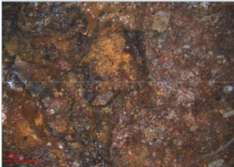
Figura 4.2.2.A Superficie de la probeta precorroída con agua de mar, a un aumento de 20x.
