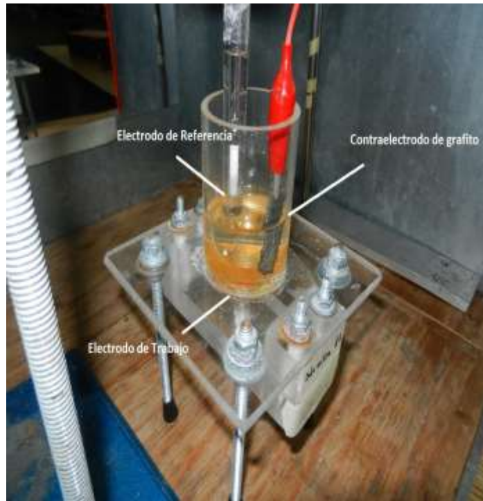
Figura 3.2.A Muestra la configuración de electrodos empleada para la técnica de EIS, R_p , curvas de polarización.
