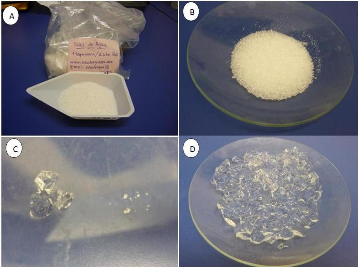
Figura 2.) A y B) Lluvia sólida® en forma de un hidrogel seco con aspecto de un polvo granular fino. C) granos de hidrogel hidratado y seco. D) Hidrogel hidratado.
