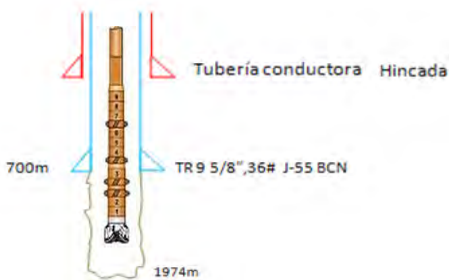
Fig. 65 Avance en la perforación hasta 1974m para el pozo Brillante 20
