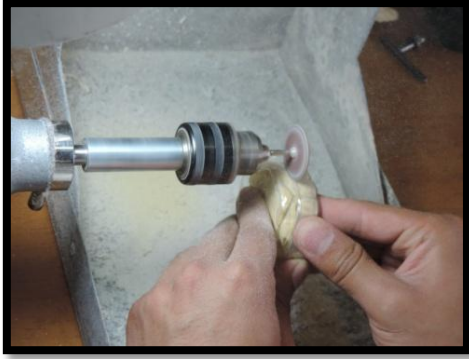
Fig. 16.7 Recorte del excedente del acetato rígido con disco de de carburo.
