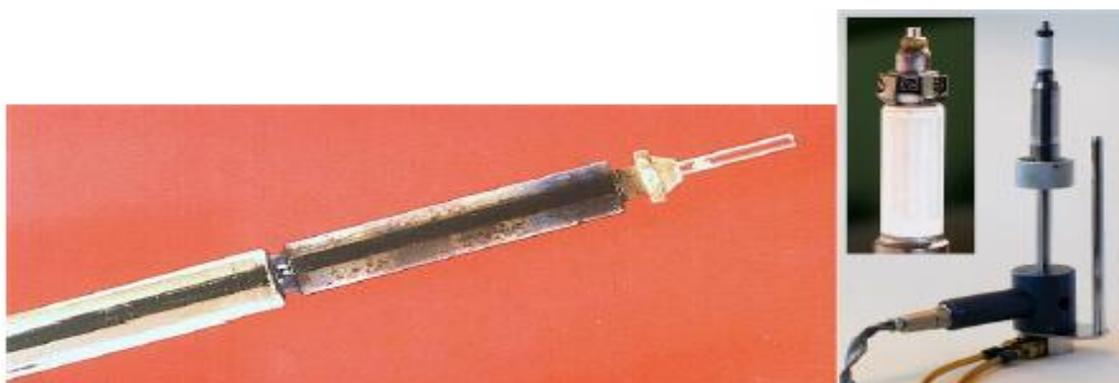
**Figura 6. Sonda de introducción directa.**
