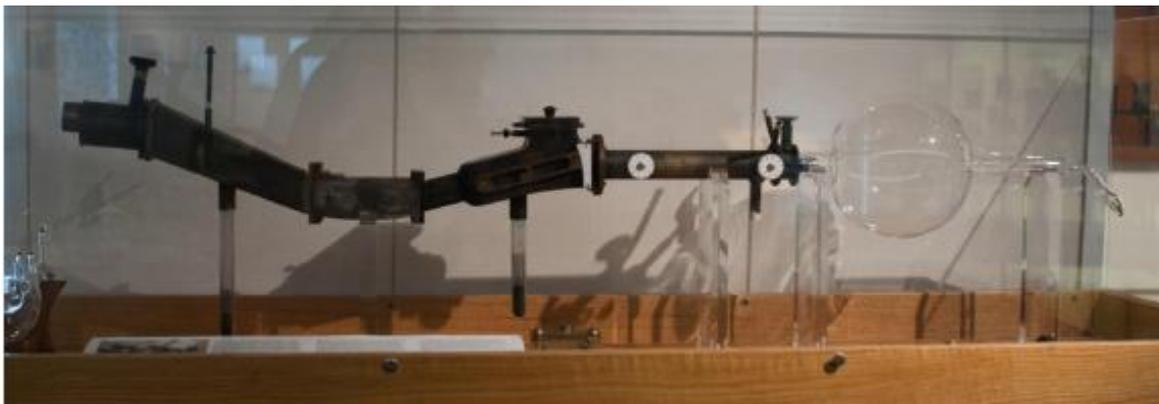
**Figura 4. Una réplica del tercer espectrómetro de masas de Aston.**
