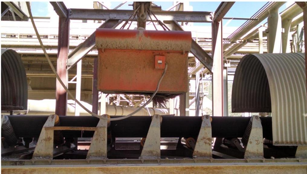
FIG. 2.45 Electroimán instalado en la banda 5a
