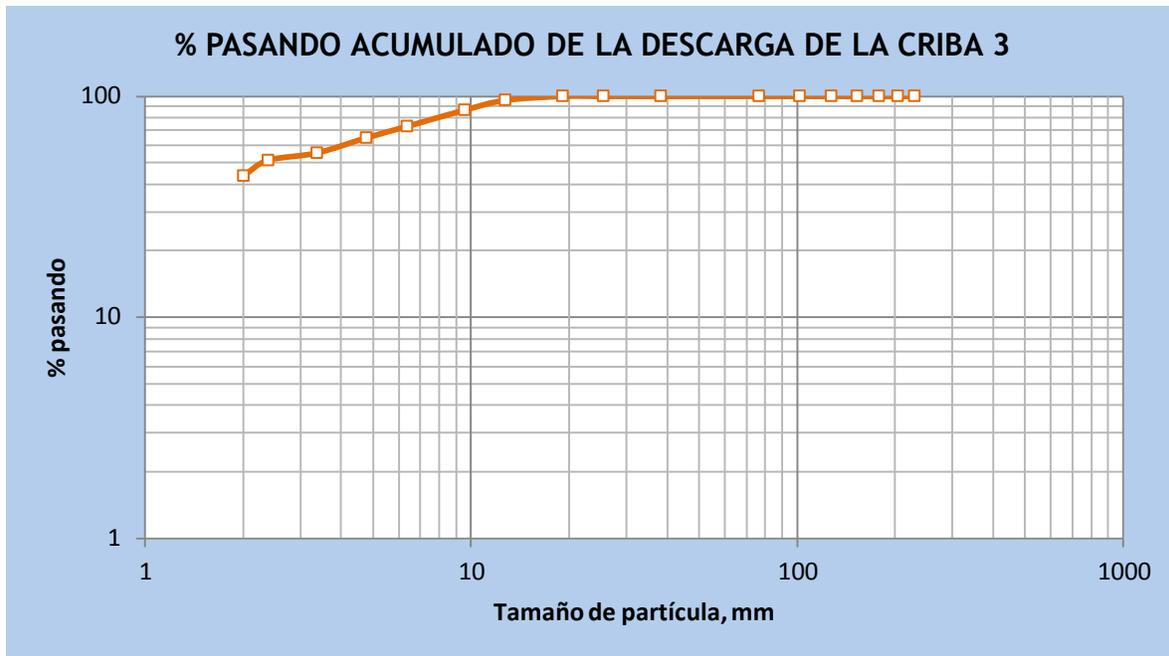
FIG. 3.4 Gráfica de % pasando acumulado de la descarga de la criba 3
