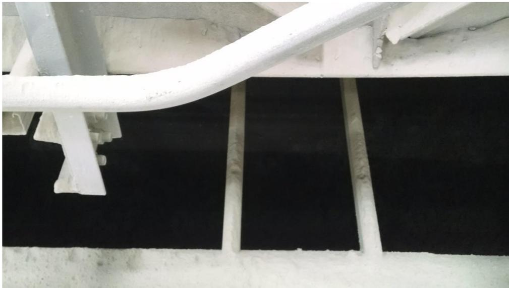
FIG. 2.13 Tolva de compensación de quebradoras secundarias vacía
