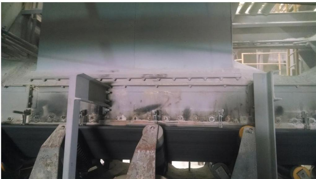
FIG. 2.43 Descarga de gruesos de quebradoras secundarias en banda 5a
