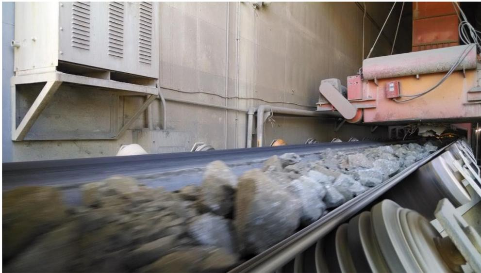
FIG. 2.36 Electroimán instalado en banda 3ª
