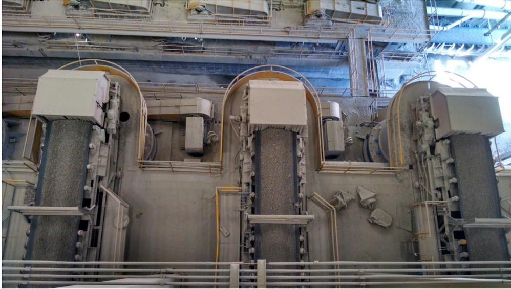
FIG. 2.64 Alimentación por bandas a quebradoras terciarias
