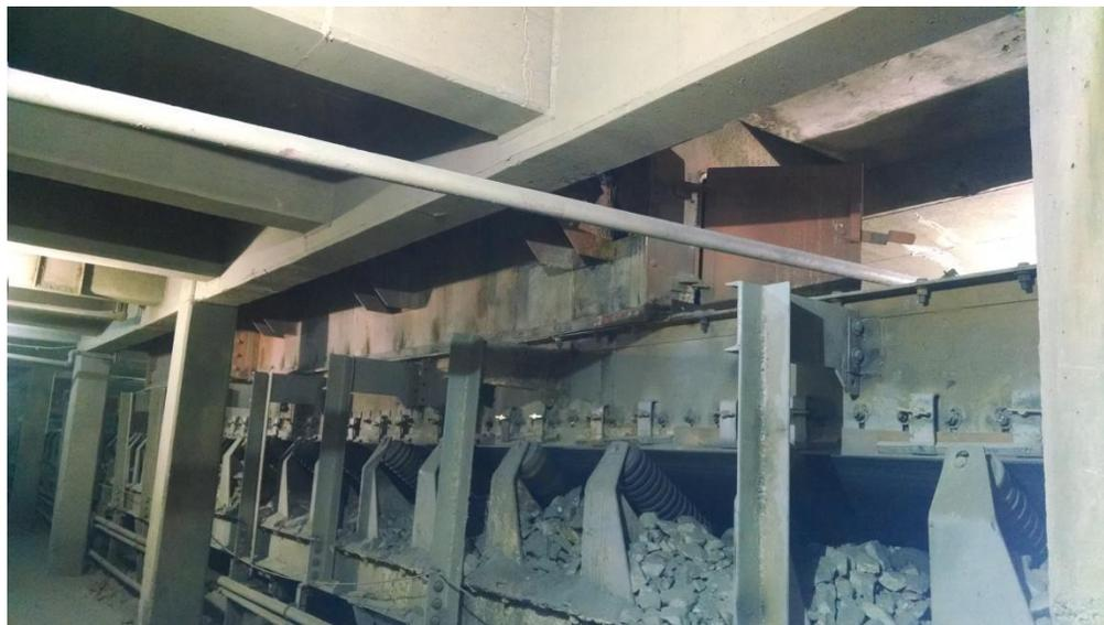
FIG. 2.5 Chutes de descarga en banda 3a
