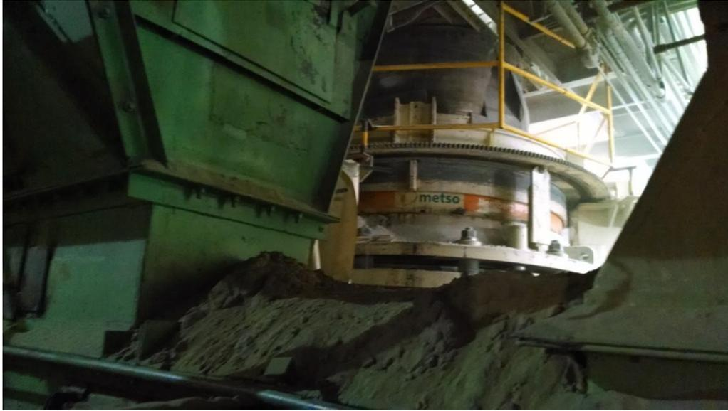
FIG. 2.20 Descarga de finos de cribas en banda 9
