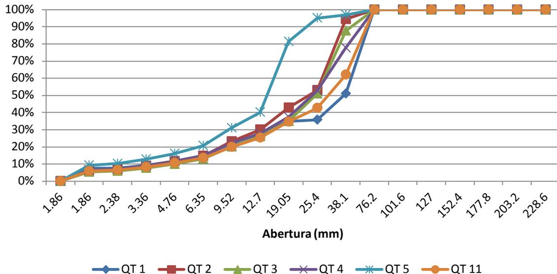
Fig. 4.15 Curvas de rompimiento de las quebradoras terciarias
