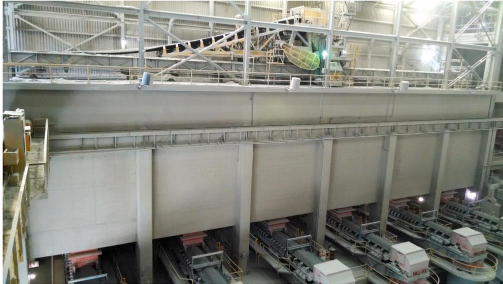
FIG. 2.26 Tolvas de compensación de quebradoras terciarias
