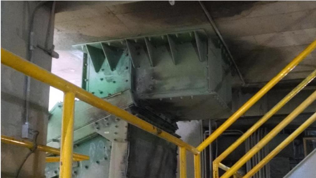
FIG. 2.18 Alimentación a criba de quebradoras secundarias
