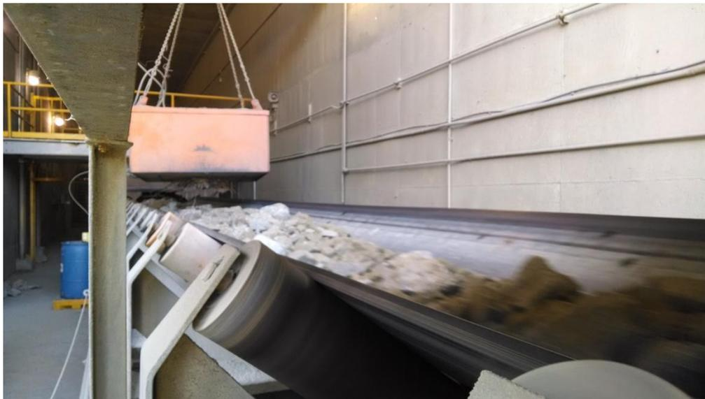
FIG. 2.38 Electroimán instalado en banda 3b
