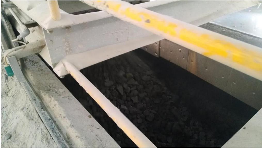
FIG. 2.16 Descarga de mineral del tripper 4b a la tolva de compensación de la quebradora secundaria
