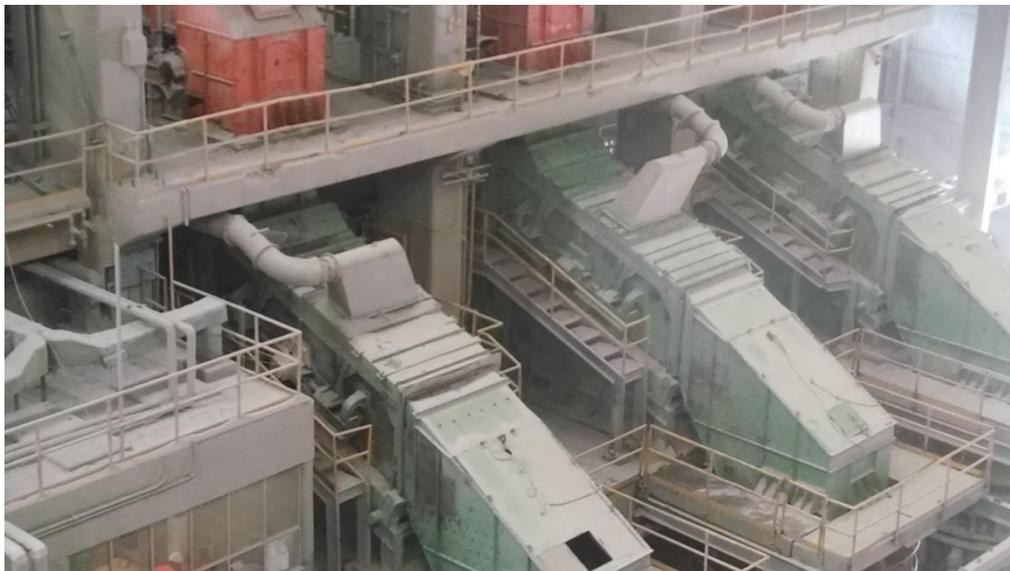
FIG. 2.19 Alimentadores y cribas de quebradoras secundarias
