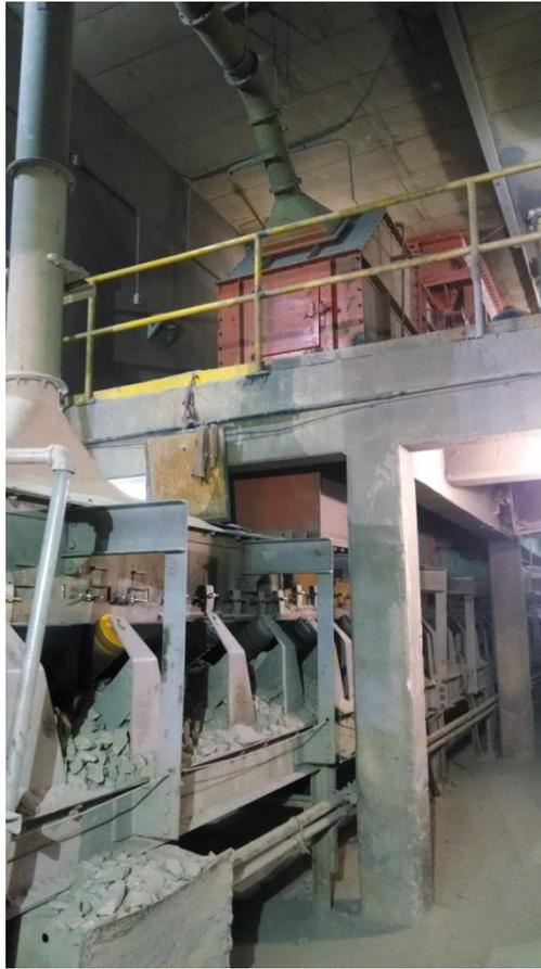
FIG. 2.4 Chute de descarga a banda 3a
