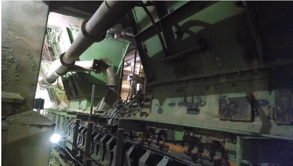
FIG. 2.52 Descarga de finos de cribas en banda 9a
