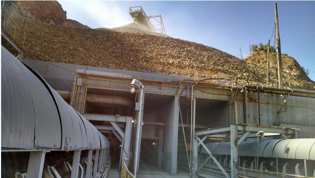
FIG. 2.2 Salida de las bandas 3a y 3b del almacén de gruesos
