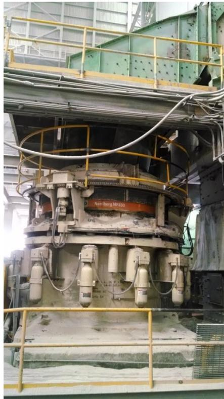
FIG. 2.22 Alimentación de criba a quebradora secundaria
