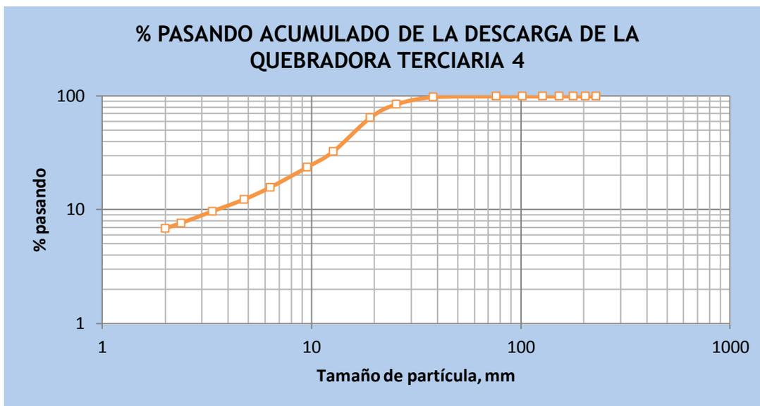
FIG. 3.13 Gráfica de % pasando acumulado de la descarga de la quebradora terciaria 4
