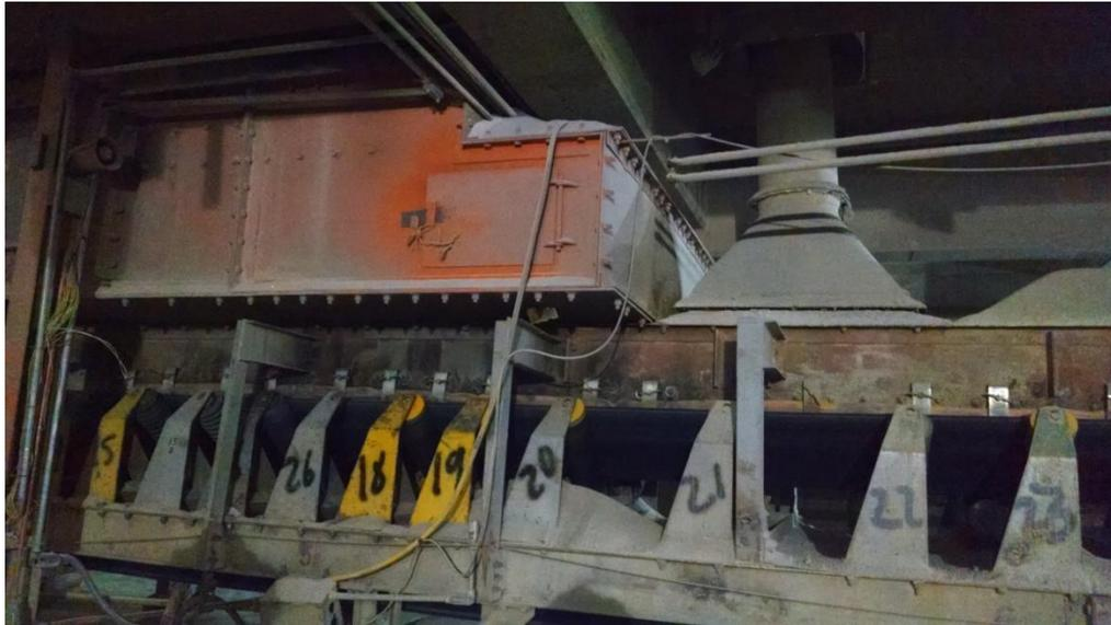
FIG. 2.31 Descarga del mineral en la banda 1
