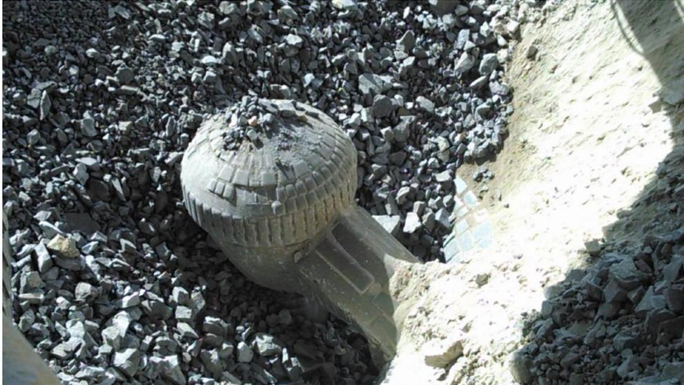
FIG. 2.57 Quebradora primaria giratoria con carga
