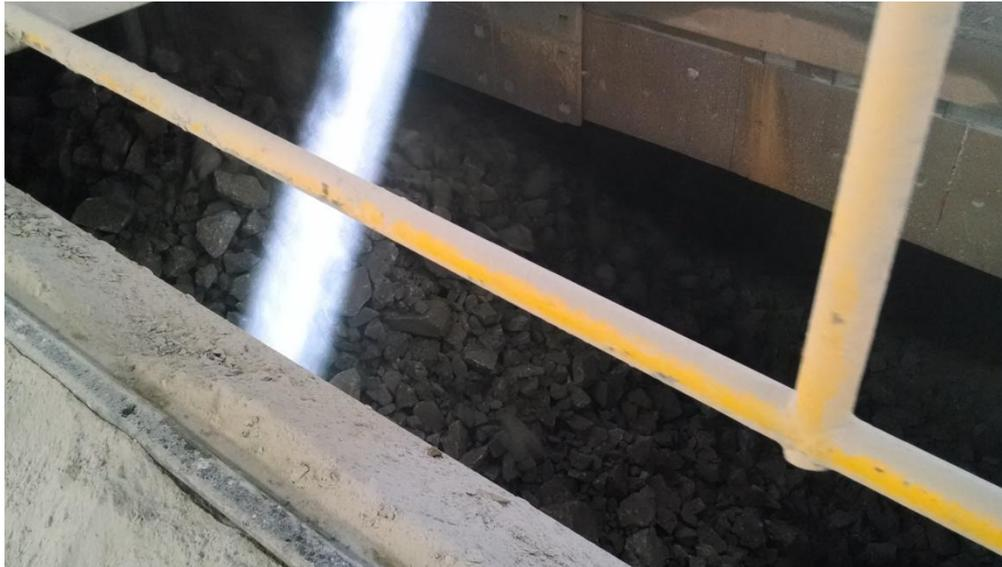
FIG. 2.14 Tolva de compensación de quebradoras secundarias llena
