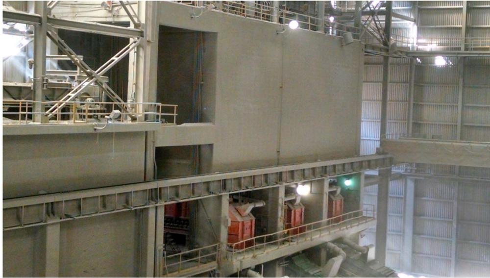
FIG. 2.12 Tolvas de compensación y alimentadores a cribas de quebradoras secundarias
