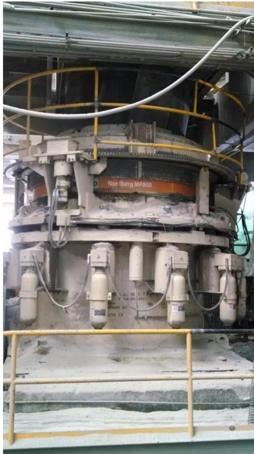
Fig. 2.61 Quebradora secundaria METSO MP800
