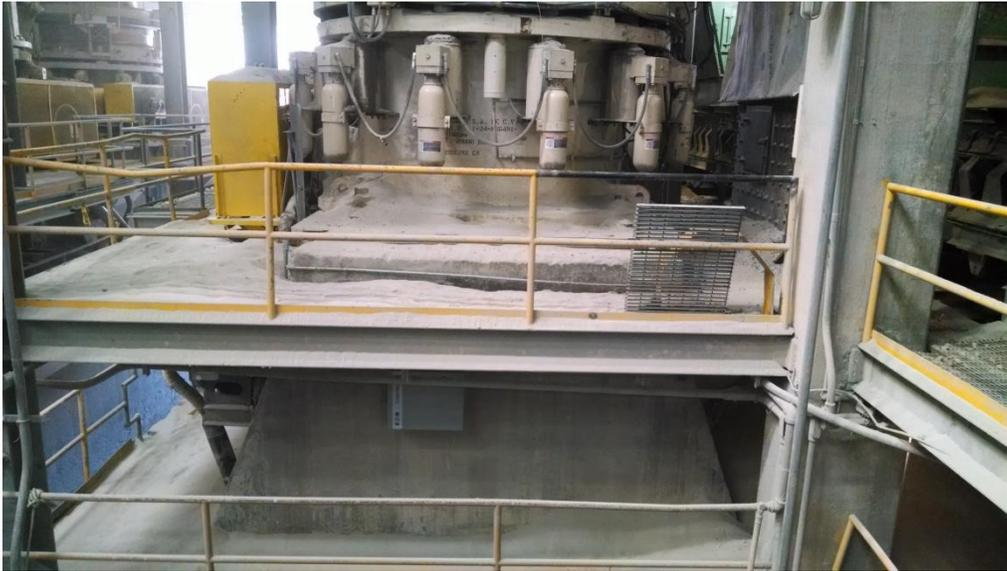
FIG. 2.62 Pistones hidráulicos de quebradora secundaria
