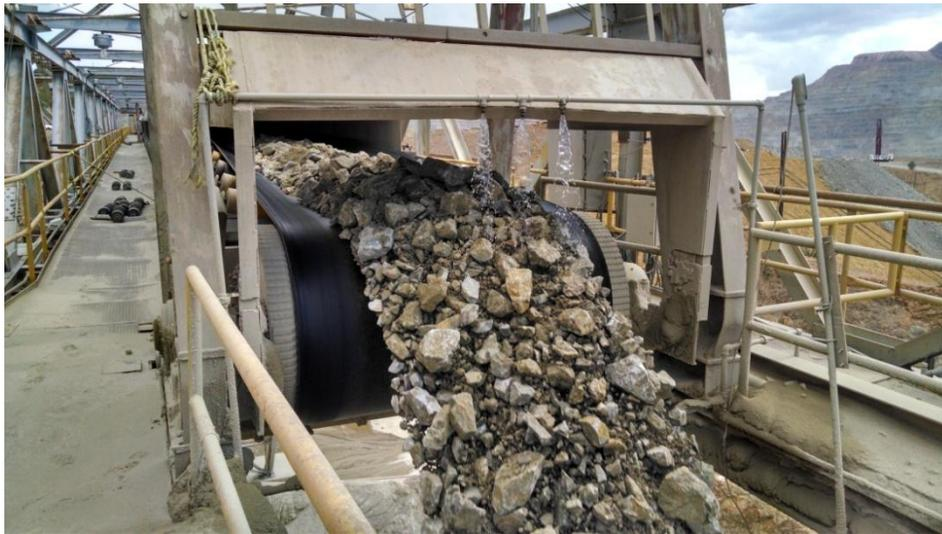
FIG. 2.34 Descarga del mineral de la banda 2 al almacén de gruesos
