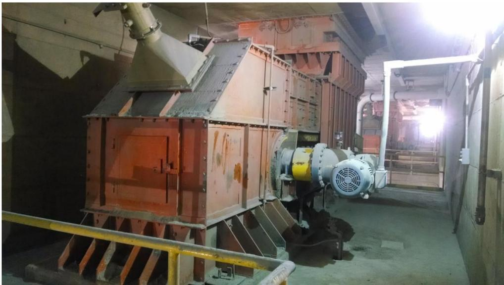
FIG. 2.3 Alimentadores de placas del almacén de gruesos a banda 3a
