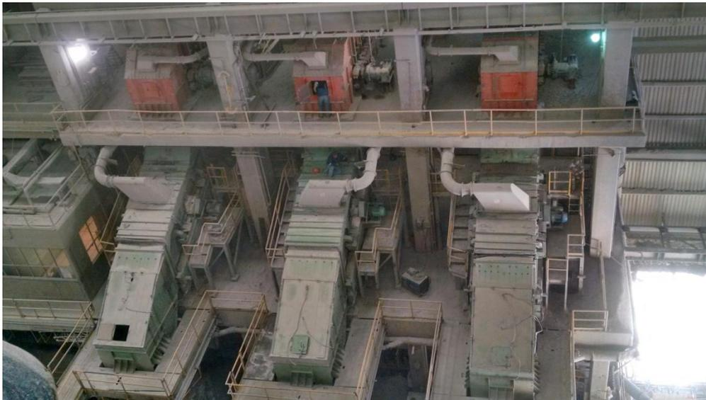
FIG. 2.68 Vista de las 3 cribas vibratorias instaladas en el lado A de la planta de trituración
