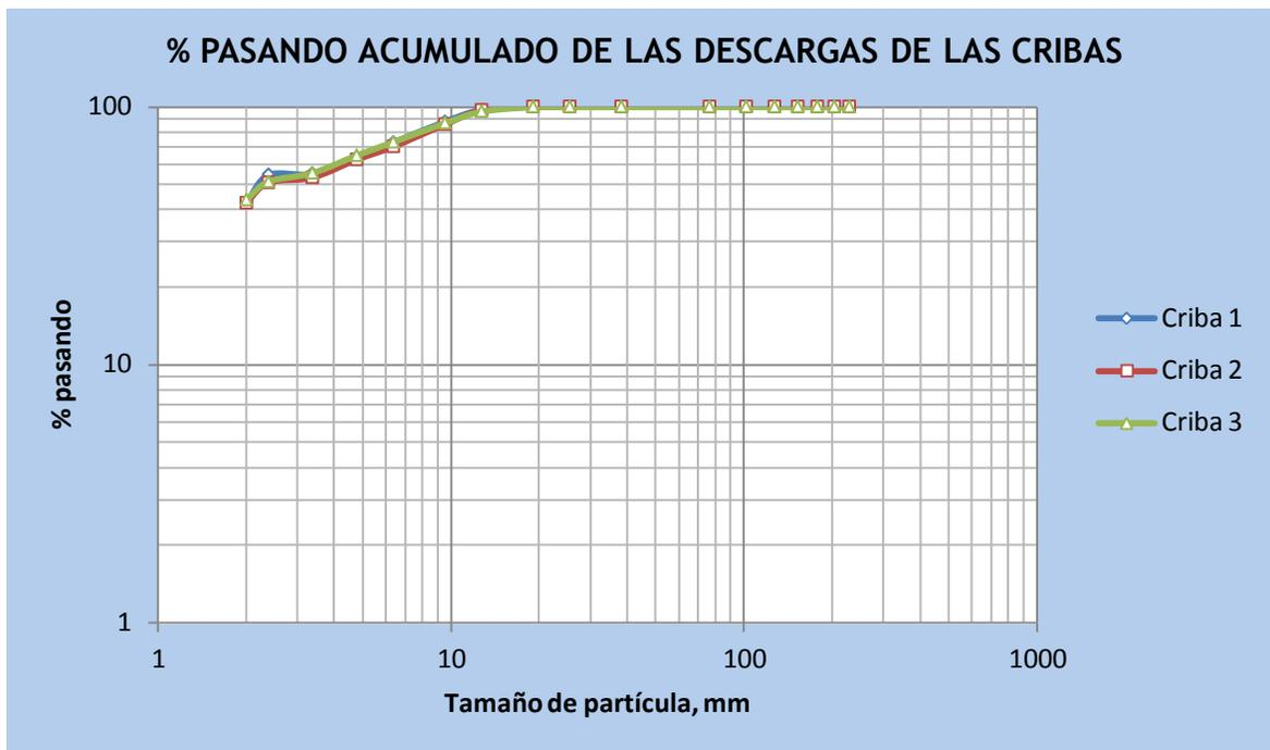
FIG. 3.5 Gráfica de % pasando acumulado de las descargas de las cribas de alimentación a quebradoras secundarias
