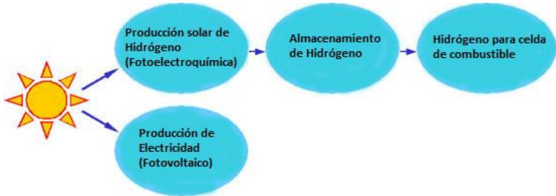
*Figura 9 La luz solar se puede usar como fuente de energía para iniciar la reacción fotoelectroquímica o directamente para producir electricidad mediante una celda fotovoltaica<sup>36</sup>.*
