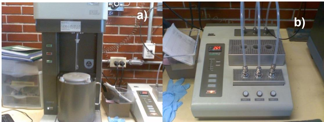
*Figura 25* Equipo para análisis de área superficial por el método BET (equipo Minisorp-II Bel Japan). a) Equipo de adsorción, b) equipo de desgasificación.
