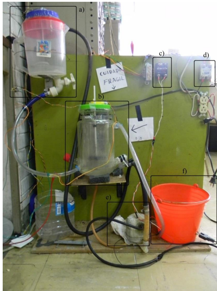
Figura 5.3 Sistema de control de temperatura desarrollado.
