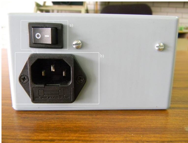
Figura B.9 Vista inferior del gabinete, a) Interruptor de encendido, b) Toma de alimentación.
