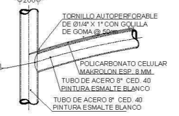
DETALLE ANCLAJE DE TUBO COLUMNA TIPO C-2
