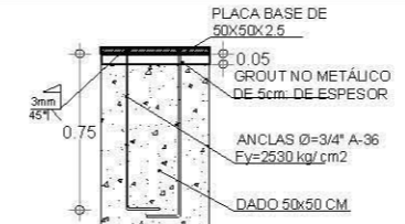
DETALLE ANCLAJE DE PLACA COLUMNA TIPO C-2
