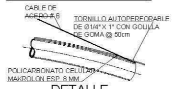
DETALLE POLICARBONATO COLUMNA TIPO C-2
