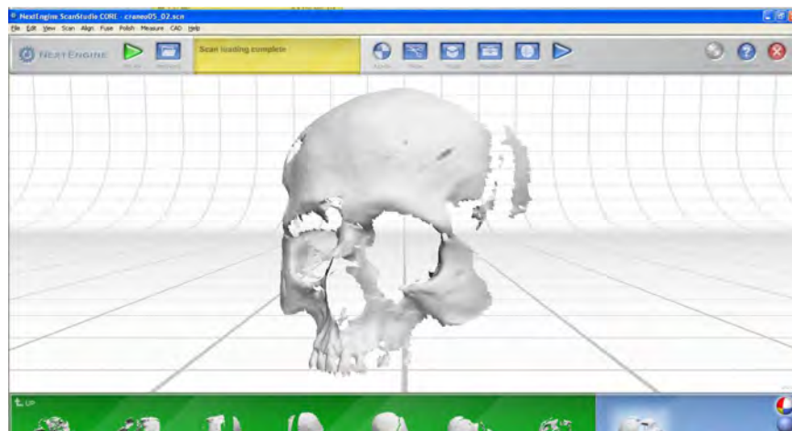
Fig. 36: Obtención de los cortes de uno de los cráneos. En la zona verde aparecen representados todos los cortes que se utilizarán para reconstruir el cráneo.
