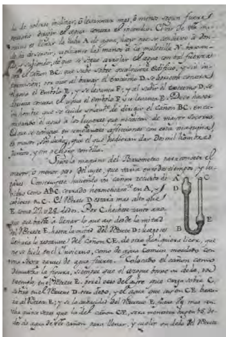
Figura 33. Construcción de un barómetro, que sirve para medir la presión atmosférica, según Tosca, para conocer el mayor o menor peso del aire que varía en tiempo y lugar. A la derecha, aparece la figura 34, sobre la construcción de un termómetro, especificando su utilidad para conocer los grados de calor y frío que tiene el aire. Se fundaban en la rarefacción y condensación del aire.
