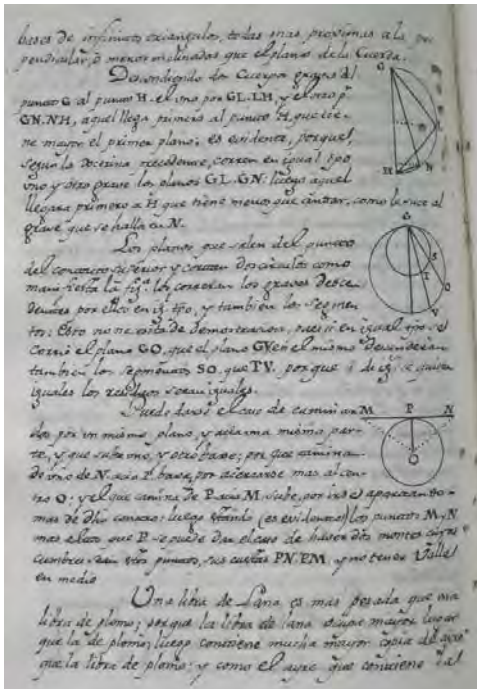
Figura 47. Demuestra el cuerpo que llegará más rápido de dos cuerpos lanzados por las líneas inclinadas desde el punto superior del círculo al inferior.
