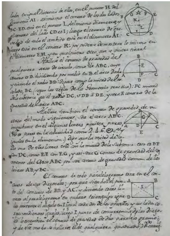
Figura 107. Centro de gravedad en un pentágono.
