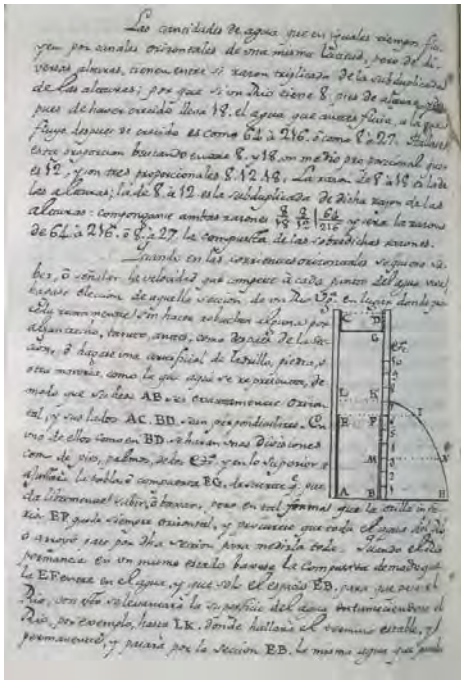
Figura 36. Regla general para medir el agua que fluye en cualquier género de canales horizontales o inclinados, suponiendo que a todas las perpendiculares de la sección correspondan iguales velocidades, máximas, medias, o mínimas. Esto se realizaba a través de varios cálculos en los que intervenían las tablas de espacios congruentes, cuyo resultado demostraba el espacio que corría el agua según diferentes alturas en un minuto. Las tablas las copió Talabán de Tosca, pero no completas.
