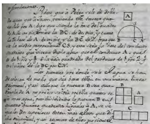
Figura 20. Explica el método a seguir para la repartición equitativa del agua, cuando en un estanque se colocan varias compuertas. El dibujo superior, es una variante que Talabán inventó y no copió de Tosca.
