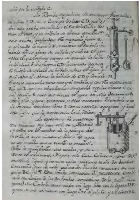
Figura 31. Bomba hidráulica, llamada de expulsión, instrumento útil que servía para llenar pilas, acequias y estanques. Tosca le denominó bomba hidráulica atractiva y Talabán por expulsión, su diseño y mecanismo era muy parecido a la anterior.
