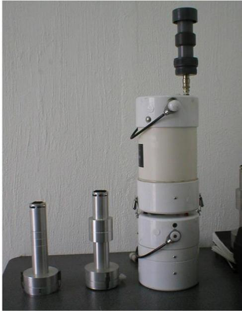
**Muestreadores para partículas suspendidas PM 2.5, PM 1. 0 y muestreador MiniVol.** Imagen tomada de: <http://df.gob.mx/index.php/sistema-de-monitoreo-atmosferico-de-la-ciudad-de-mexico>, acceso 15 de abril de 2014.
