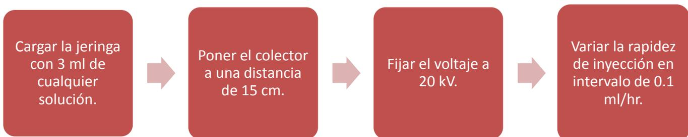
**Paso 3.** Con el voltaje y la rapidez de inyección, se buscó la distancia óptima para el electrohilado. El proceso se describe a continuación. La distancia se varió desde los 5 cm hasta los 30 cm:
