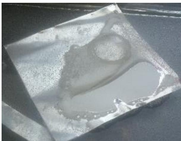
Figura 26: Membrana de quitosano/PVA electrohilada, 20 kV, 20 cm y 0.1 ml/hr en una solución acuosa de NaOH 2M
