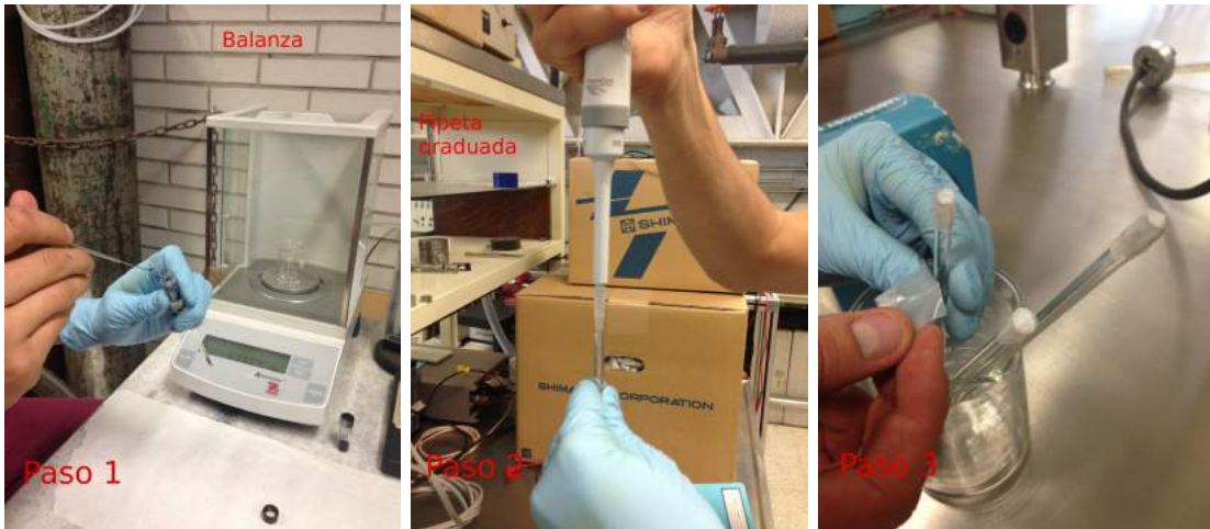
Figura 7-2: Proceso para colocar los NTCPM y los reactivos en los tubos de ensayo . Paso 1 colocar los NTCPM, paso 2 colocar el reactivo y paso 3 sellar con parafilm.
