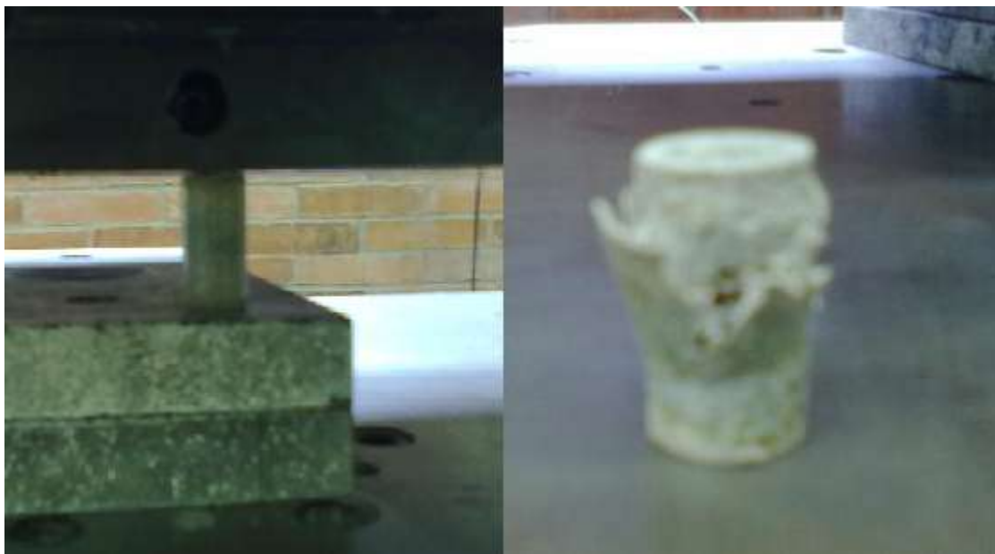
Figura 3.2 Probeta antes y después de aplicar el ensayo de compresión.
