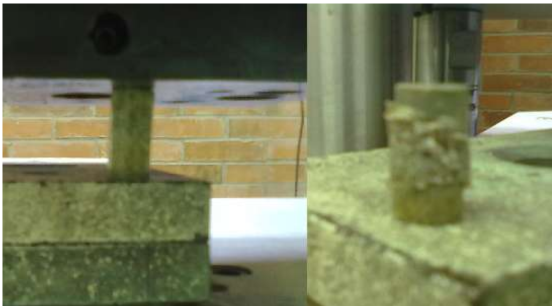
Figura 3.3 Probeta antes y después de aplicar el ensayo de compresión.
