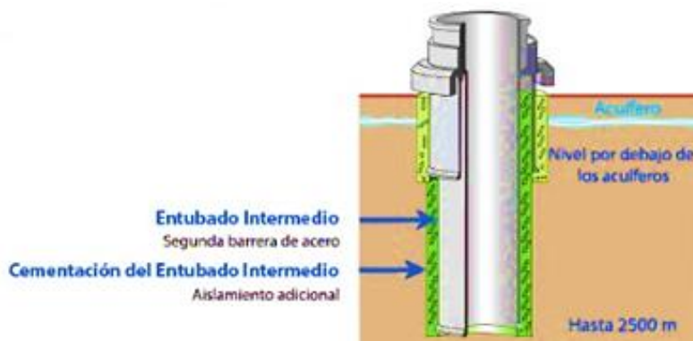
Figura 3.32: Entubado intermedio y cementación de alta resistencia (BNK, 2012)
