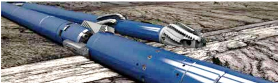
Figura 3.22: Cuña desviadora para pozos en agujero descubierto (Schlumberger, 2012)
