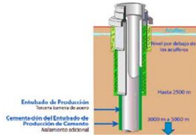
Figura 3.33: Entubado de producción y cementación de alta resistencia (BNK, 2012)
