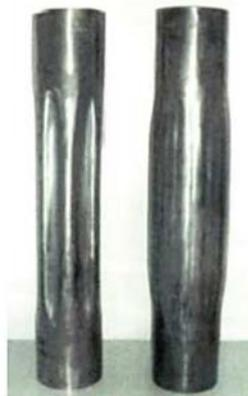
*Figura 10.3.1 Proceso de expansión con agua, antes y después.*
