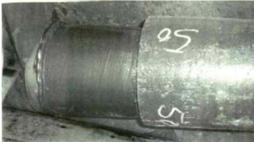
Figura 10.1a Mandril utilizado para deformar permanentemente tubería sólida expandible
