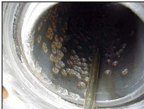
Figura 3.1.2a Efectos de corrosión por CO<sub>2</sub> conocida como "pitting".
