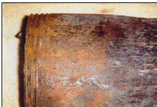
*Figura 3.1.1 Efectos de corrosión y desprendimiento en una conexión API*
