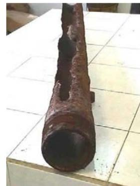
Figura 3.1.2c Efectos graves de corrosión por H<sub>2</sub>S
