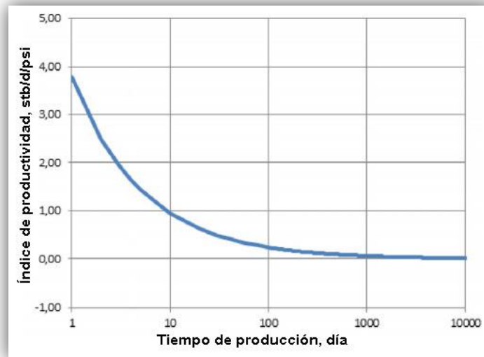
Figura 3.3 Gráfica de producción vs tiempo de los yacimientos de shale (Modificado de Khan, 2014).
