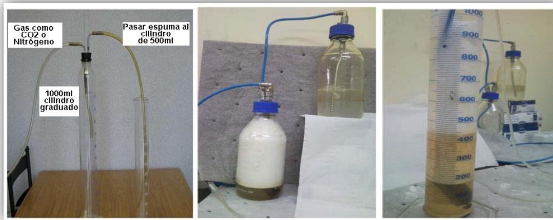
Figura 5.4 Prueba de laboratorio para determinar el rendimiento de los productos (Modificado de Farina, 2012).
