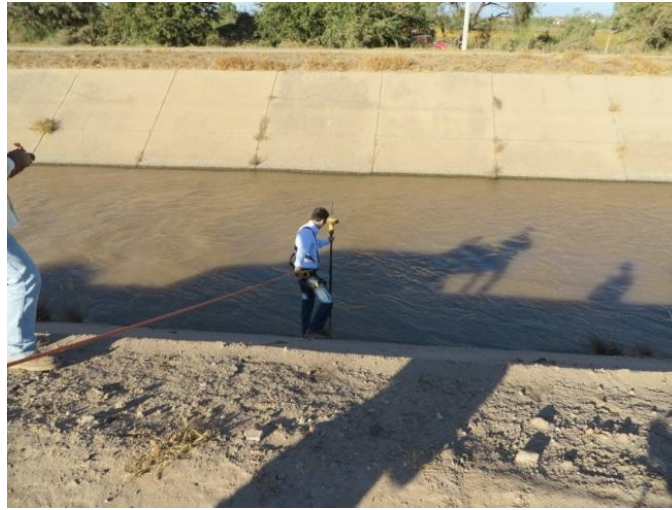
Fotografías 6.11. Obteniendo los niveles con el equipo RTK.
