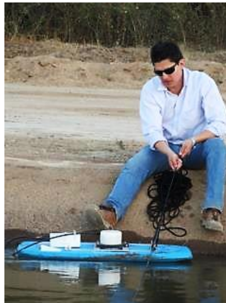
Fotografía 6.12. Utilizando el perfilador vertical de efecto doppler móvil.
