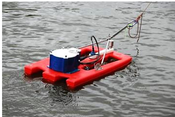
Fotografía 6.10. Perfilador vertical de efecto doppler móvil.
