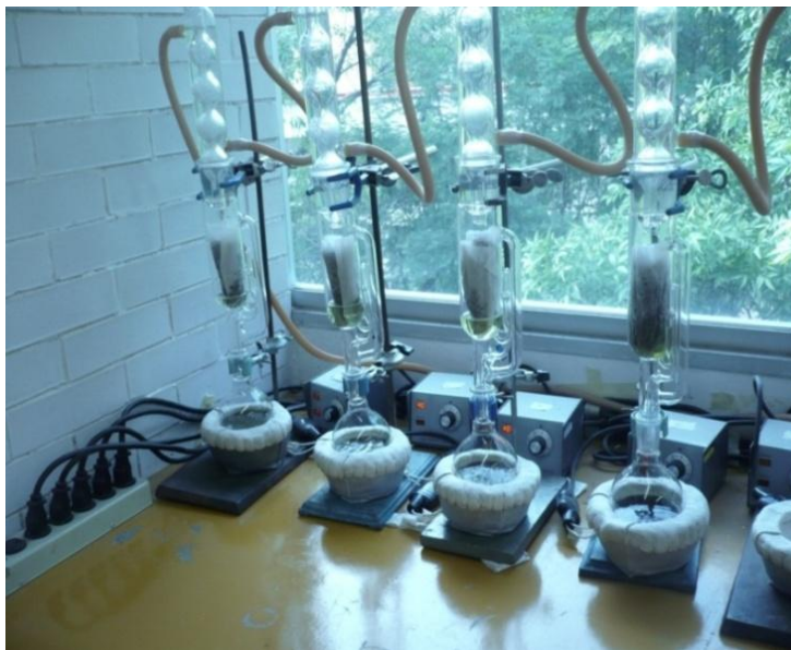
Figura 3. Equipo Soxhlet, Facultad de Ciencias UNAM
