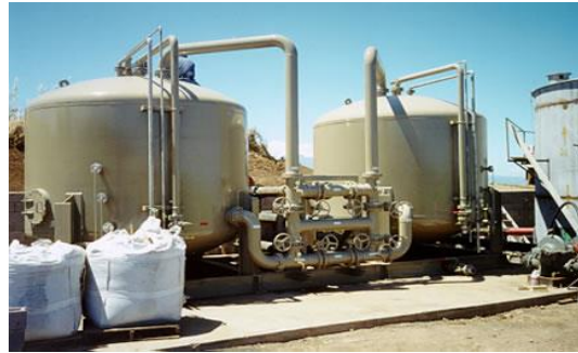
Figura 8 Recipientes de carbón activado para la remoción de H 2 S (American Biogas Council).
