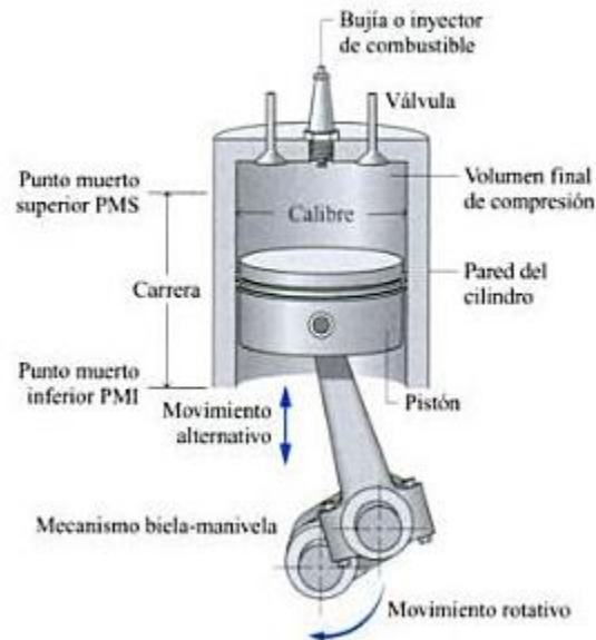
Figura 23 Nomenclatura para motores de combustión interna alternativos.
