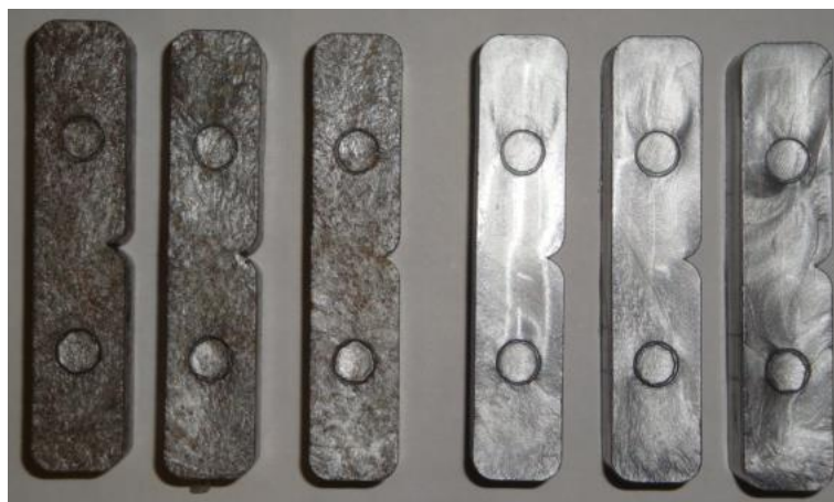
Figura 24. Probetas fabricadas según la norma ASTM D256 para ensayos de impacto.
