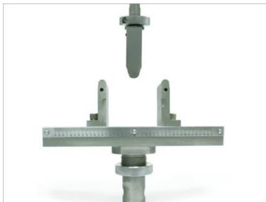
Figura 37. Herramental involucrado en el ensayo a flexión en tres puntos. Parte inferior cruceta graduada, parte superior nariz que aplica la carga.
