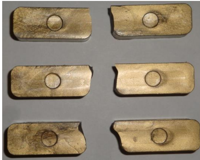
Figura 26. Probetas de impacto ensayadas, en composición 100%PPr
