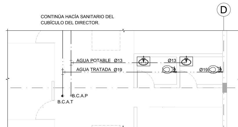
01 BAÑO ÁREA DE OFICINAS BM.HI.PB.01 | BM.HI.DT.02 ESC 1:100
