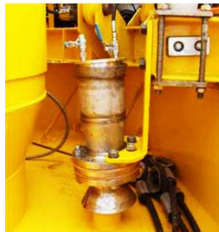
Figura 4. 15 Sensor de presión colocado en módulo de succión. 25
