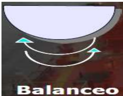
Figura 1. 17 y Figura 1. 18 Movimientos en el plano vertical para un equipo flotante de perforación en aguas profundas.
