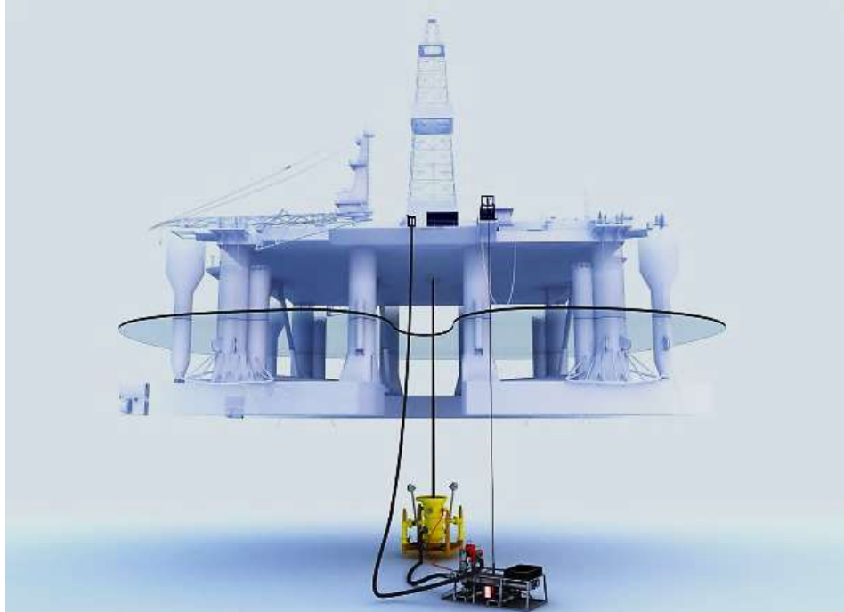
Figura 4. 8 Sistema RMR típico para perforar aguas profundas. 25
