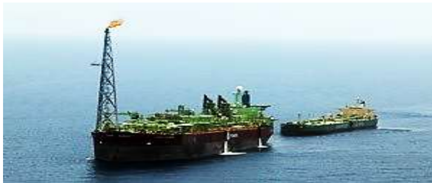
Figura 3. 4 Buque FSO utilizado para explotación y almacenamiento de petróleo.
