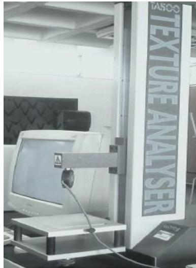
**Figura 17.** Texturómetro TA 500
