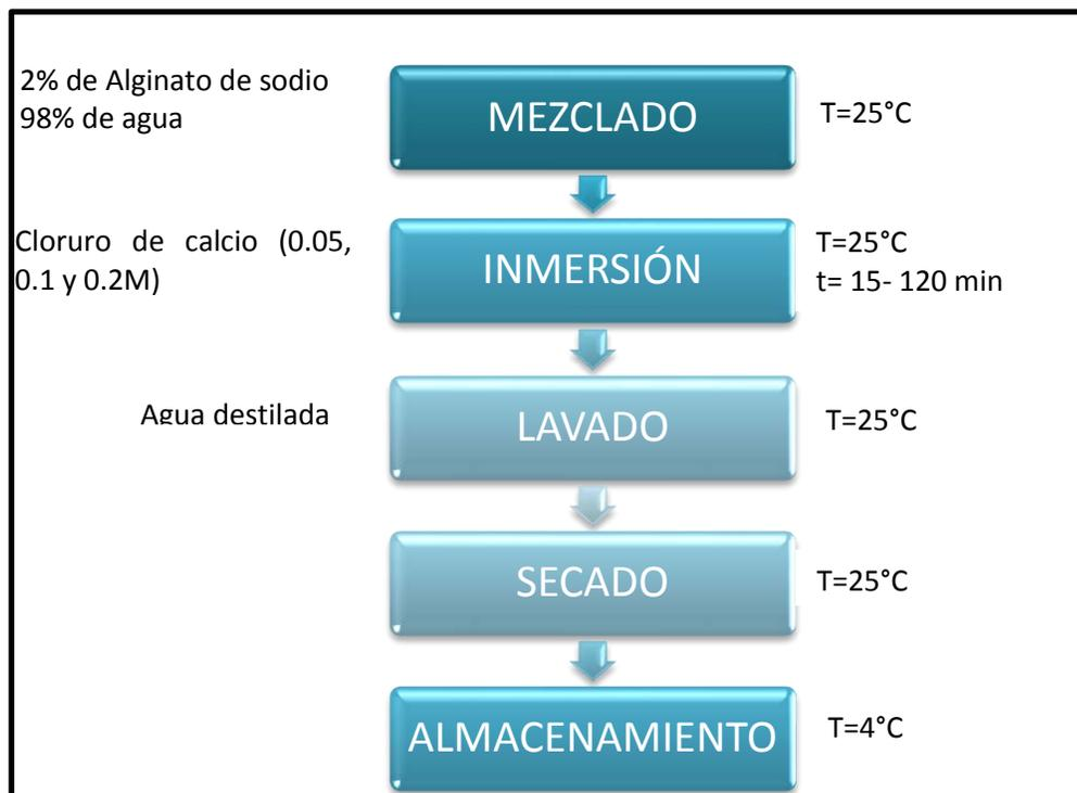
**Figura 16.** Diagrama de proceso de esferificación. Fuente: Molina, 2011
